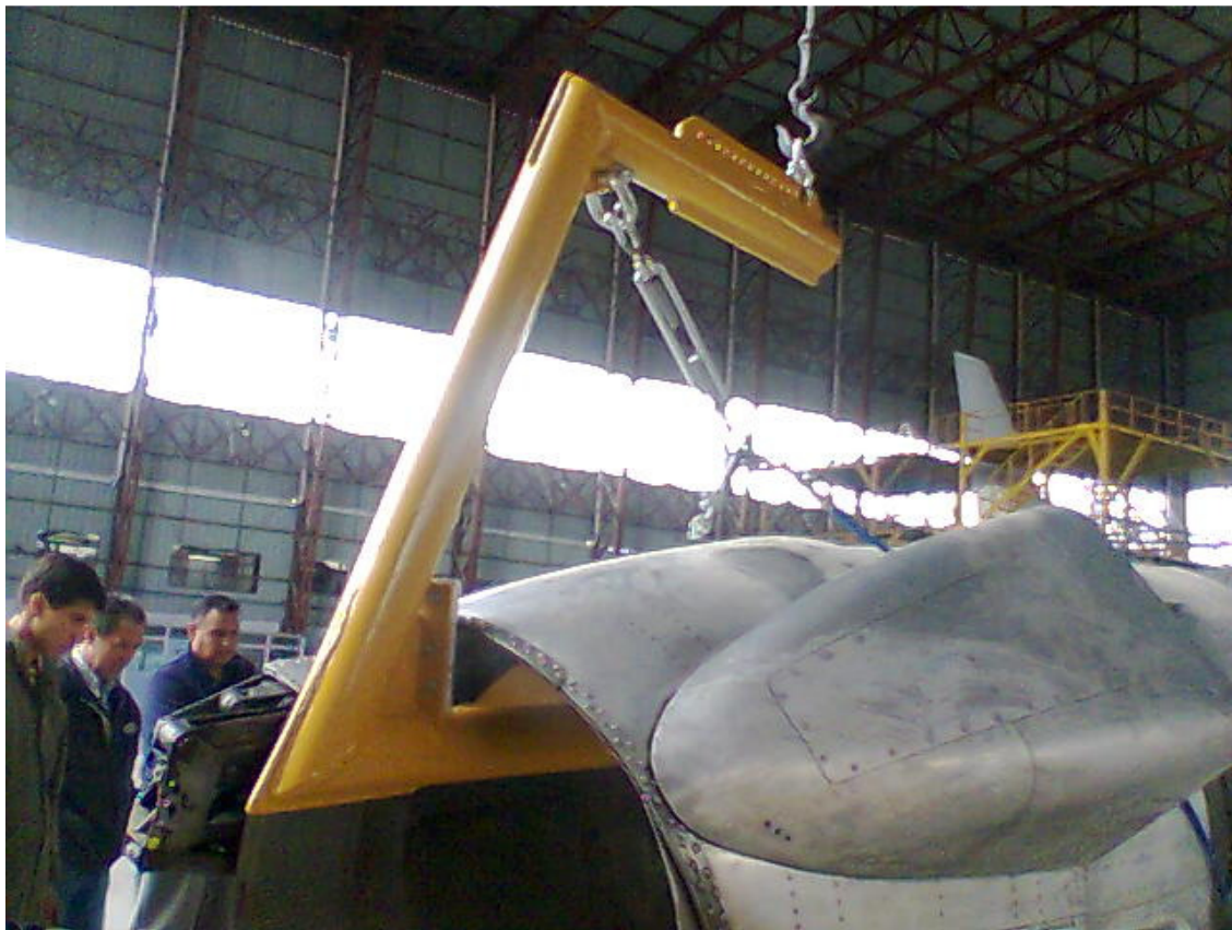
Fotos № 5.29: Prueba de Funcionamiento de la Eslinga de Izado con carga.
