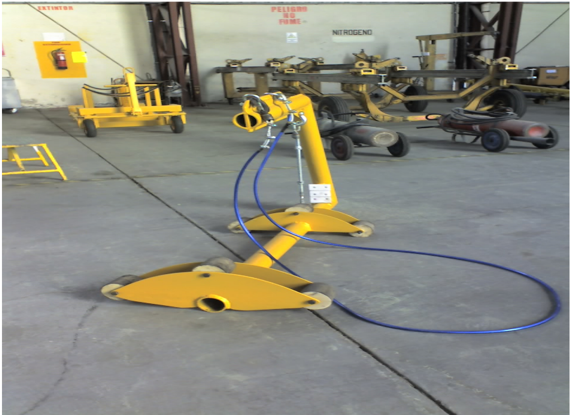
Foto Nº 5.28: Eslinga de izado para remocion de la reversa del motor JT8D.
