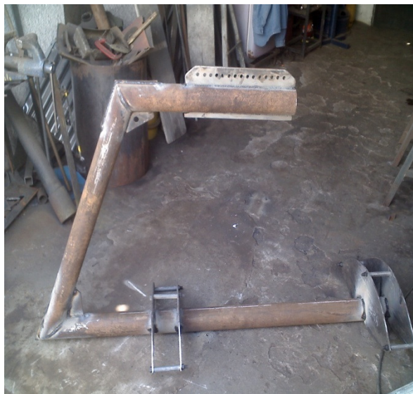
Foto № 5.24: Ensamble de la estructura de la Eslinga de Izado.
