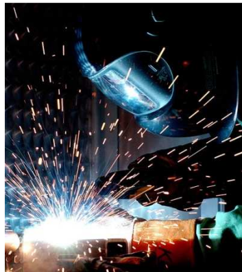
Figura 7.2 Soldadura por arco eléctrico
