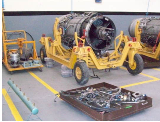
Figura 3.1 Bandejas en las cuales se coloca los componentes desmontados de los motores a reacción
