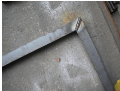
Figura 3.24 Ángulos soldados a escuadra exactamente perpendiculares Fuente: Sr. Cuatín Ruiz Víctor Yordan
