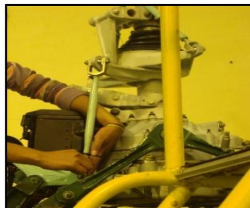
**Figura 3.30:** Instalación de la bomba hidráulica.
