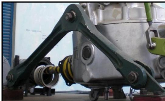
**Figura 3.26:** Dispositivo de acoplamiento de la transmisión.
