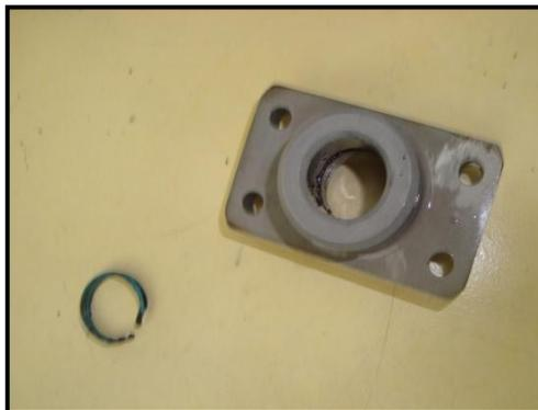
**Figura 3.35:** Empaques del servo hidráulico.
