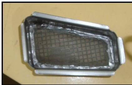
**Figura 3:** Filtro del reservorio.
