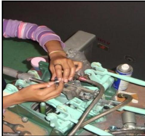
**Figura 3.32:** Instalación del servo actuador colectivo.
