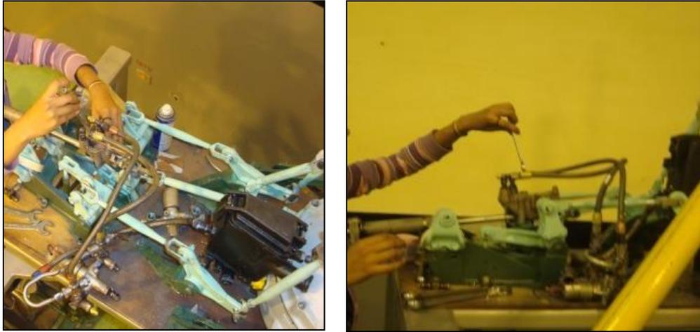
**Figura 3.33:** Instalación de las cañerías flexibles.
