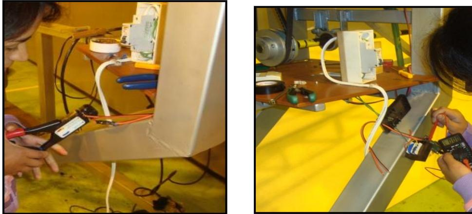
**Figura 3.31:** Instalación de la válvula solenoide.
