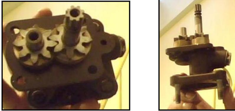
**Figura 3.3:** Bomba Hidráulica.
