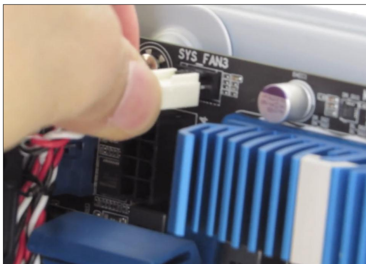
Figura 30. Alimentación en ventiladores
