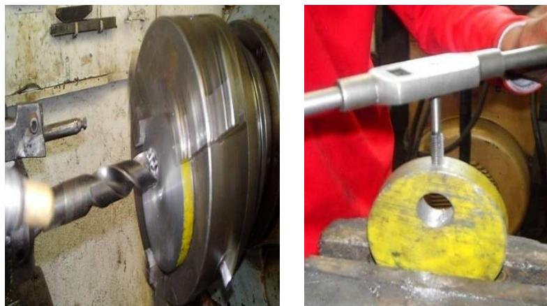
Figura3.9: Construcción de levas de vibración Fuente: Hitler Zavala
