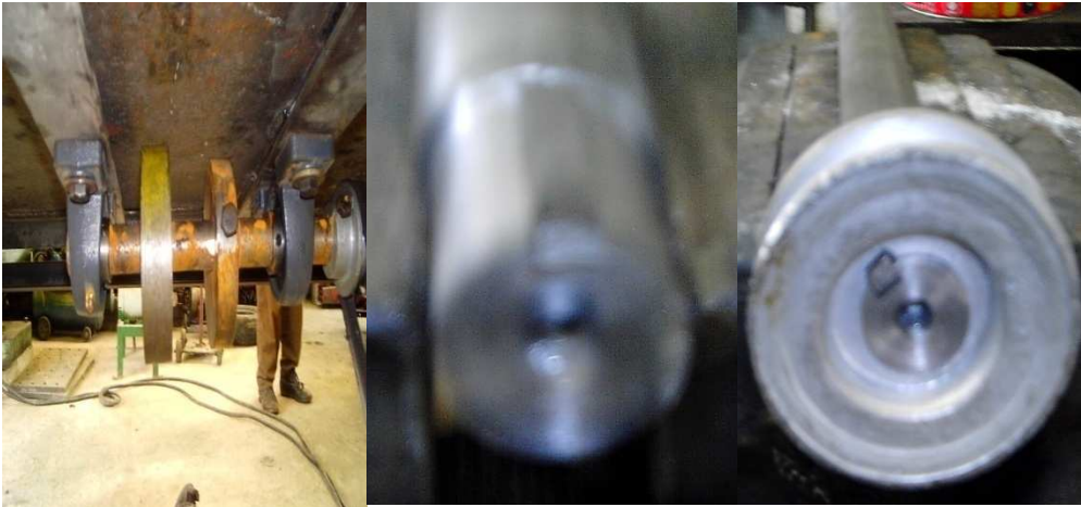
Figura3.10: Construcción del eje de vibración. Fuente: Hitler Zavala
