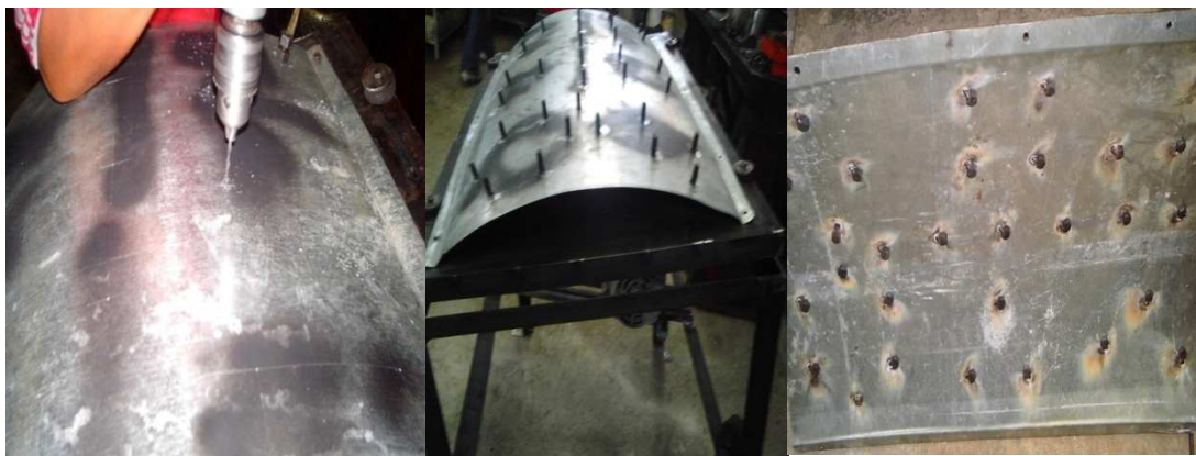
Figura3.8: Construcción de mesa superior de vibración.
