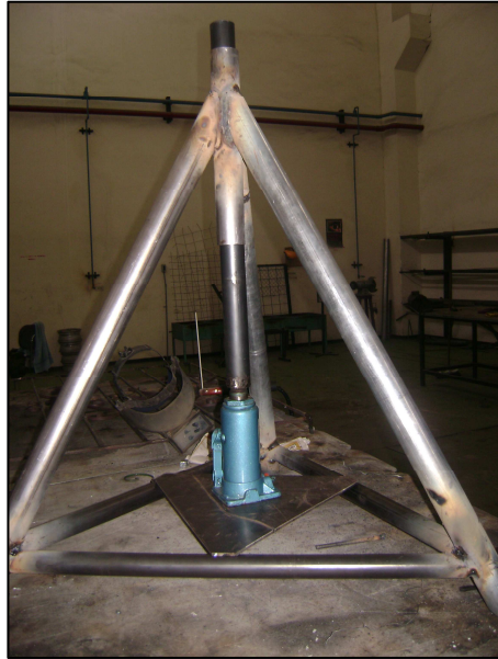
Fig. 3.23 Gata hidráulica unida al soporte
