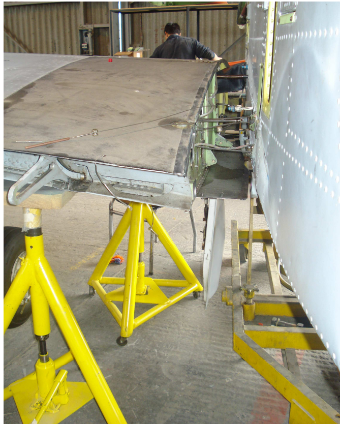
Instalación de los pernos internos que sujetan el ala con el fuselaje
