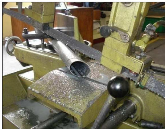
Fig. 3.11 Proceso de corte de los tubos de la estructura trípode del soporte
