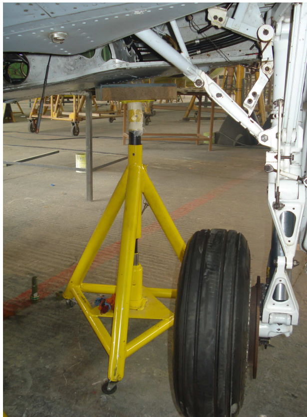
Ubicación del soporte B, en el borde de ataque del ala
