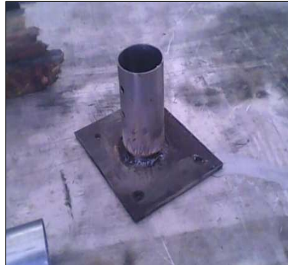
Fig. 3.25 Parte superior del soporte soldada
