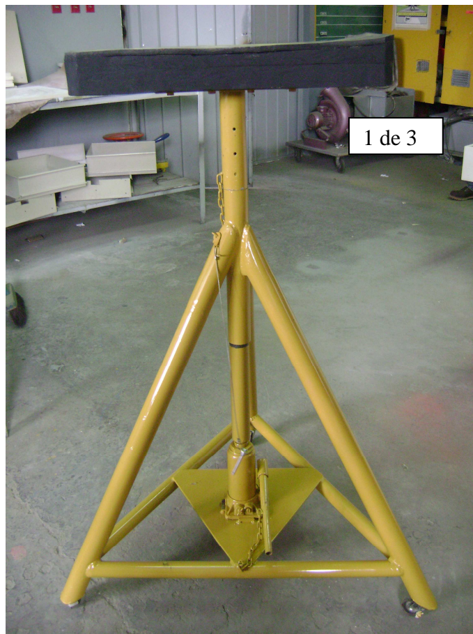
Fig. 3.27 Soporte de la punta del ala pintado
