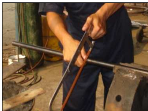
Fig. 3.15 Corte de los travesaños
