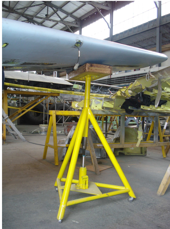
Ubicación del soporte A, en la punta del ala
