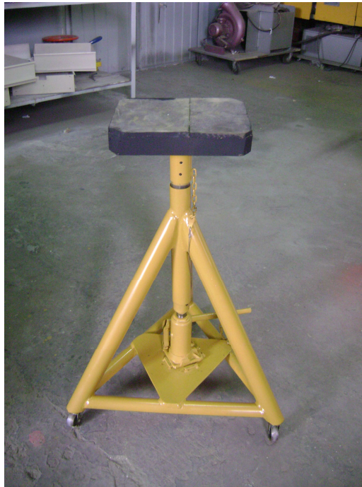
Fig. 2.5 Soporte para el desmontaje y montaje de las alas del avión T-34C-1
