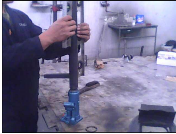
Fig. 3.21 Medición de la columna deslizante del gato hidráulico
