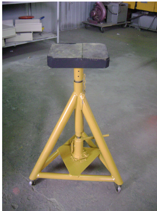
Fig. 2.6 Soporte para el desmontaje y montaje de las alas del avión T-34c-1
