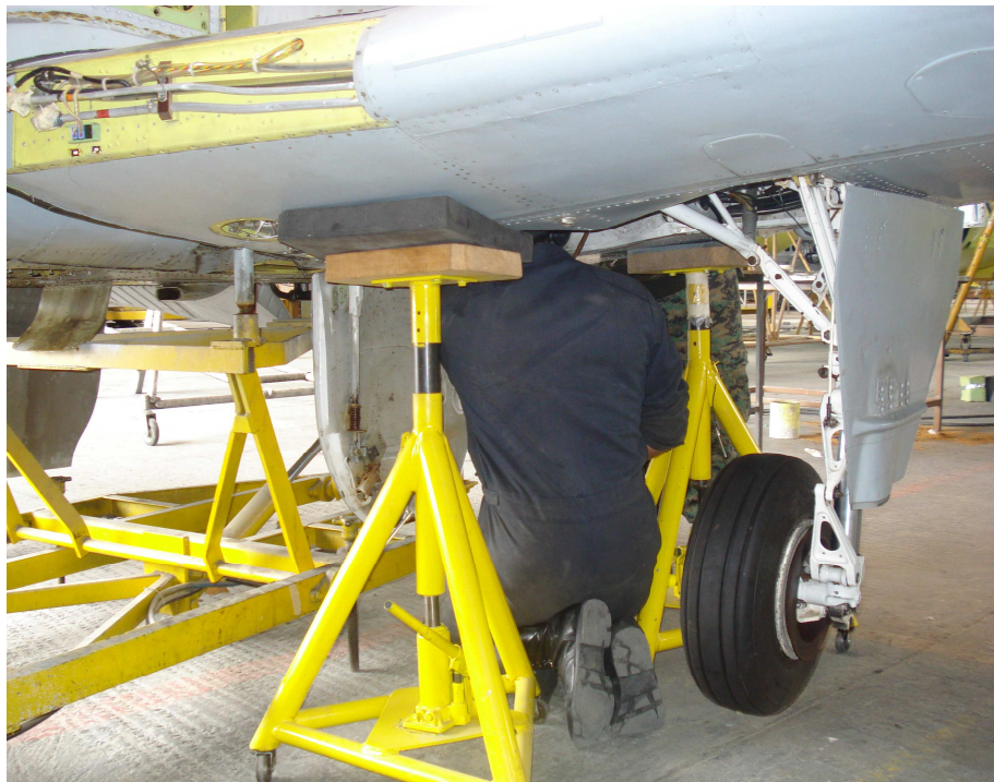
Instalación de los pernos internos que sujetan el ala con el fuselaje
