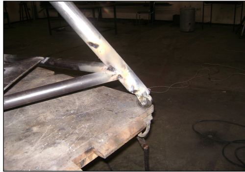
Figura 3.13 Ruedas metálicas soldadas a la estructura
