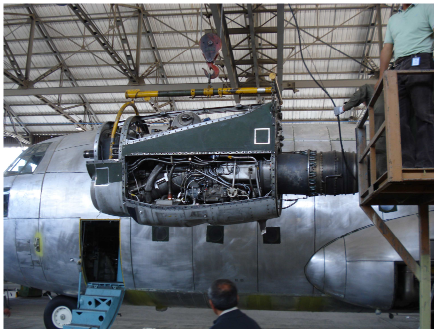
Figura 4. Proceso de desmontaje del motor Fuente: Cámara fotográfica
