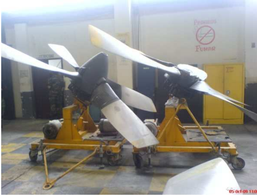
Figura 5. Hélices Hamilton Estándar del avión C-130 en sus soportes Fuente: Comando aéreo de transporte.
