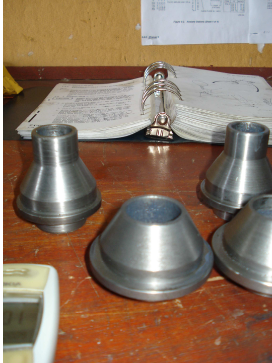
Figura 10. Juego de bujes necesarios para el anclaje del motor al soporte Fuente: Cámara fotográfica
