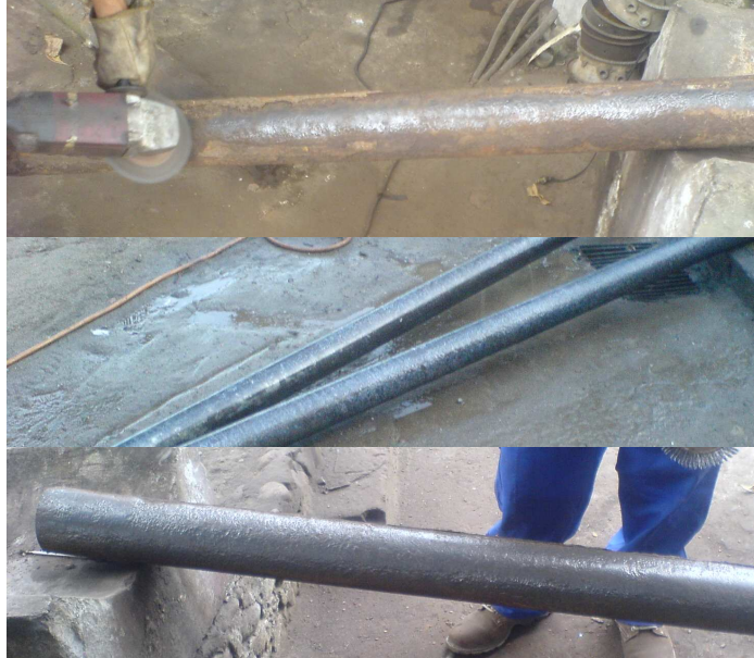
Fig. 3.7 Desoxidación de tubos Fuente: Taller industrial “Izurieta”
