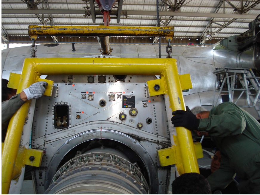
Figura 7. Proceso de anclaje del motor al soporte Fuente: Cámara fotográfica
