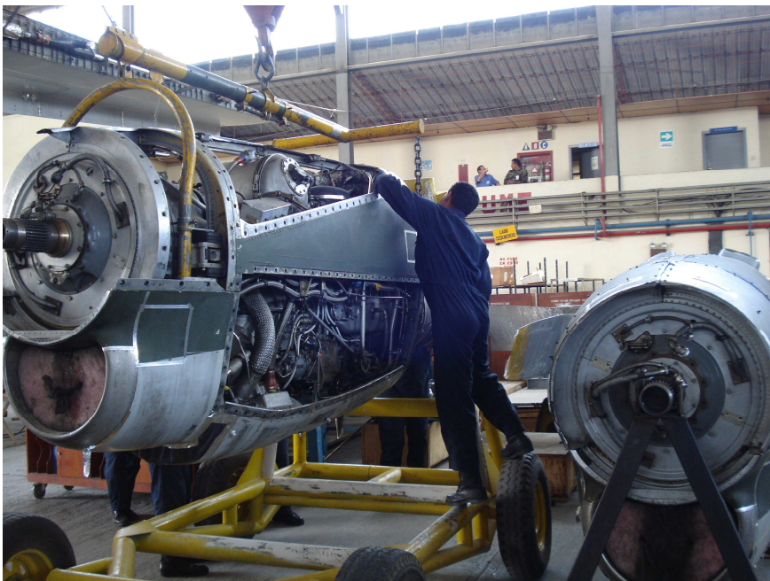
Figura 6. Proceso de anclaje del motor al soporte Fuente: Cámara fotográfica
