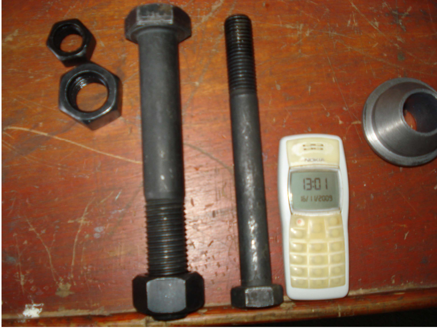
Figura 9. Juego de pernos necesarios para el anclaje del motor al soporte Fuente: Cámara fotográfica
