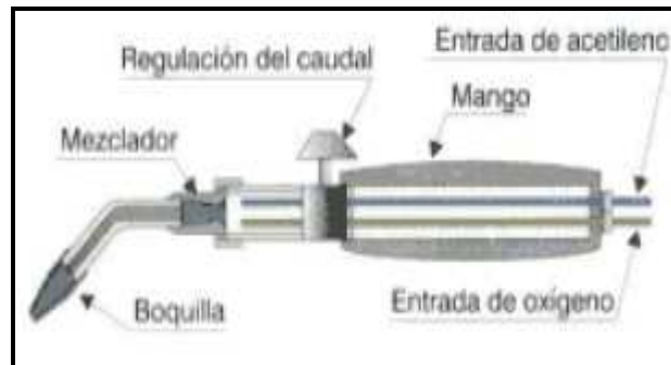
Fig. 2.7 Partes principales del soplete para corte.
