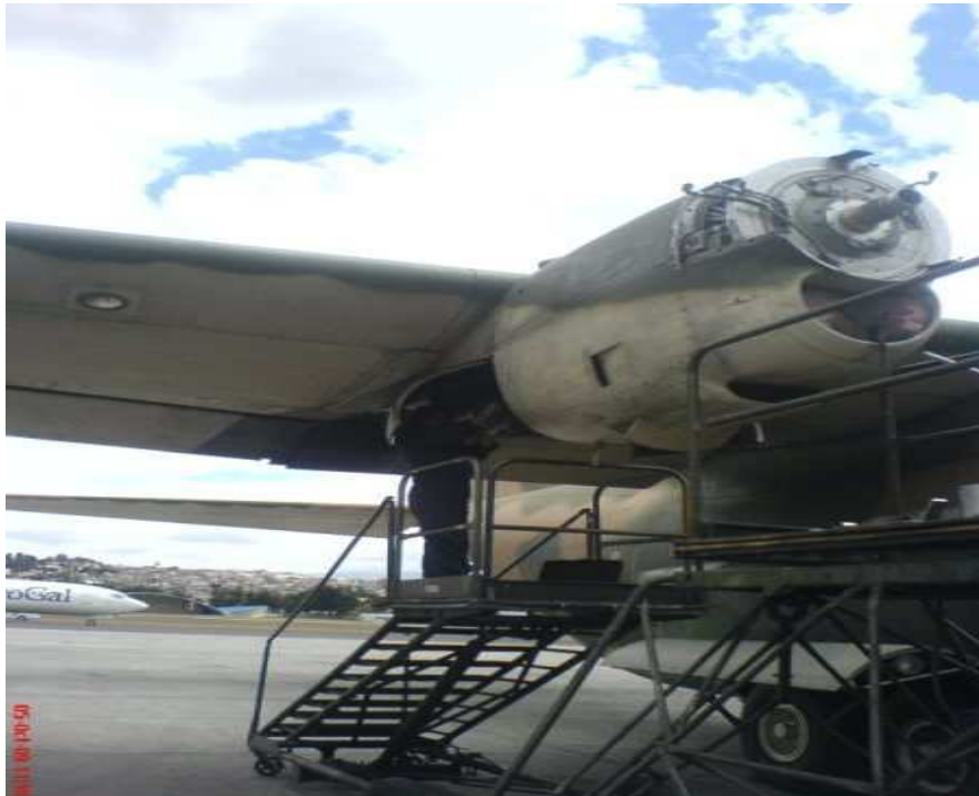
Figura 4. Motor Allison T-56 – 7 y T-56 – 15 en el avión C-130 Fuente: Comando aéreo de transporte.
