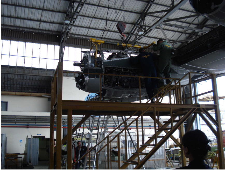
Figura 3. Proceso de desmontaje del motor Fuente: Cámara fotográfica
