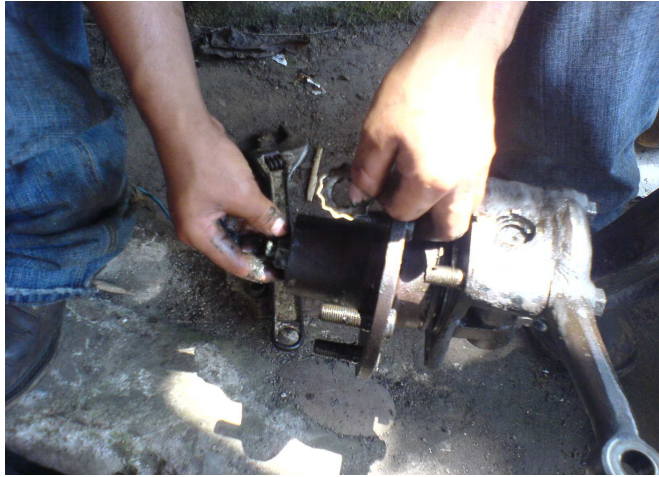
Fig. 3.14 Reparación y engrasado de las puntas Fuente: Taller industrial "Izurieta"
