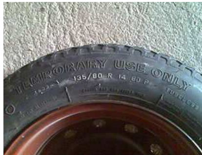
Fig. 2.14 Simbología en un neumático
