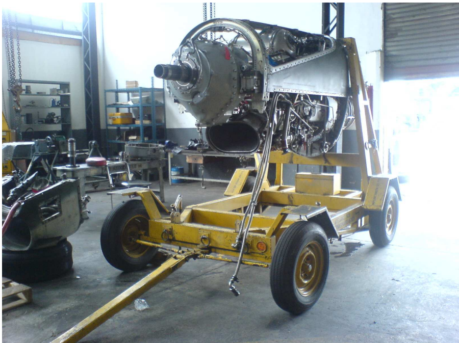
Figura 6. Motor Allison T-56 – 7 en su respectivo soporte. Fuente: Comando aéreo de transporte.
