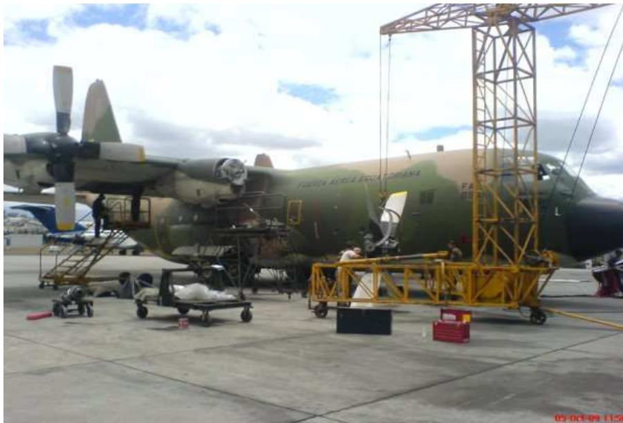
Figura 2. Desmontaje de las hélices del motor del avión C-130
