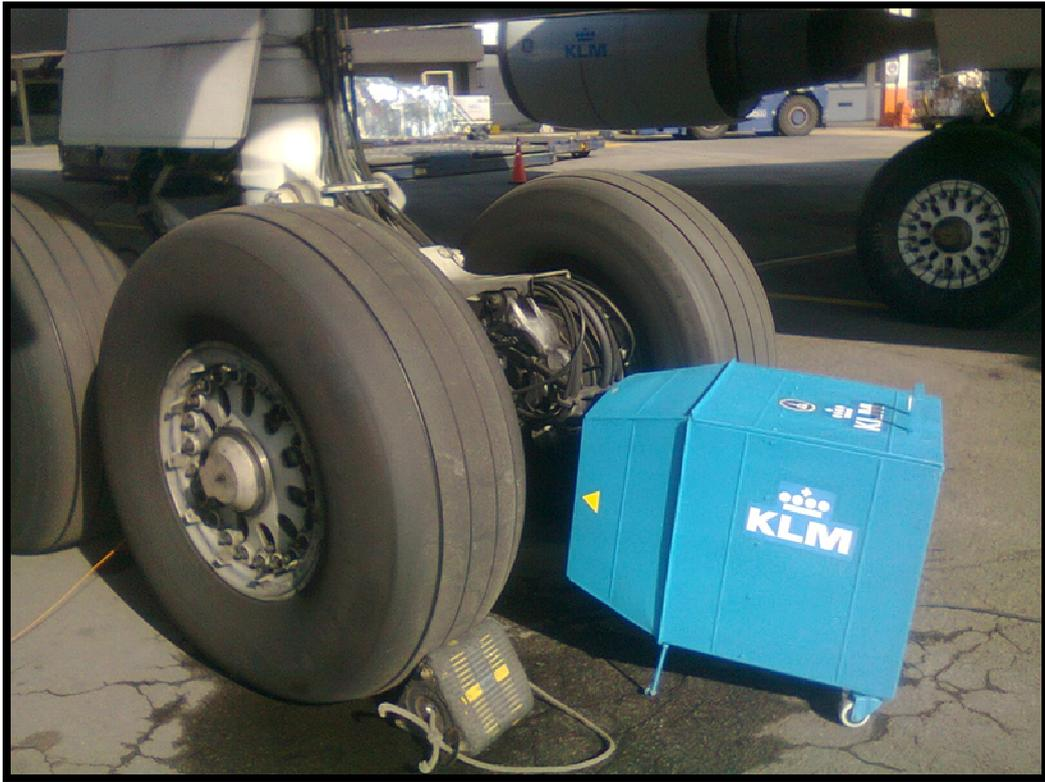
Figura E10. Sistema de ventilación totalmente finalizado.
