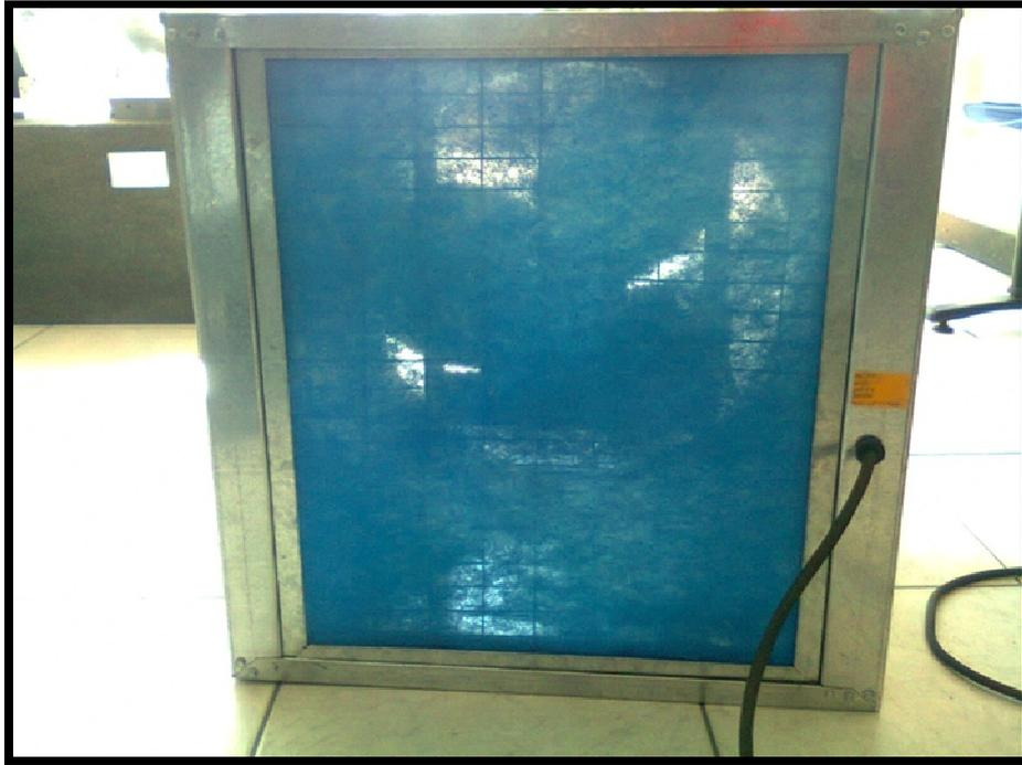
Figura E4. Chequeo del filtro de aire
