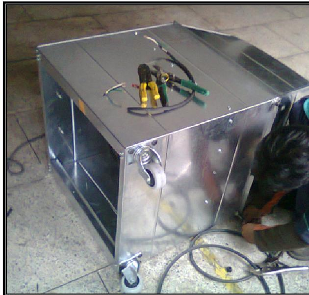
Figura 3.15 Medición de orificios para colocar las ruedas transportadora
