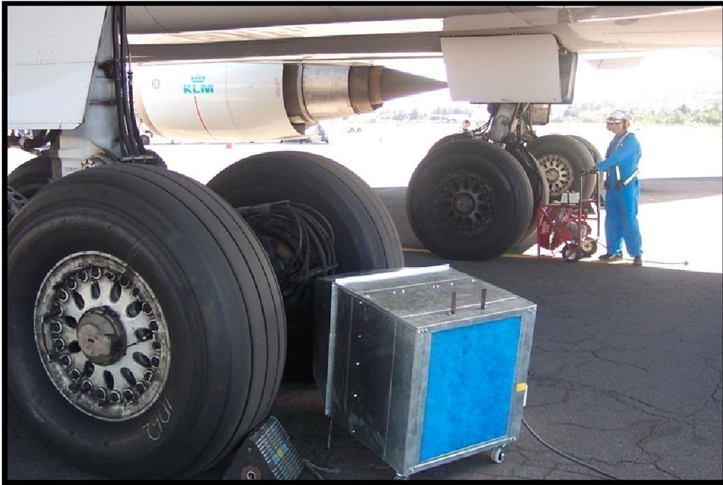
Figura E8. Colocación del ventilador de manera diagonal al conjunto de frenos
