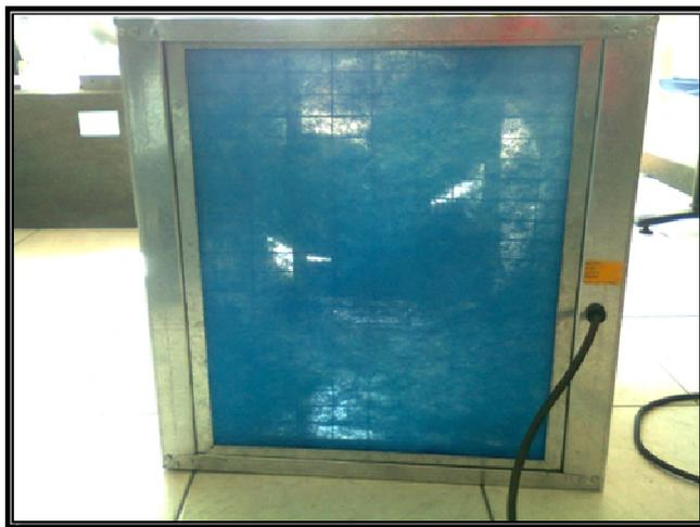
Figura 3.21 Montaje en la parte posterior del ventilador
