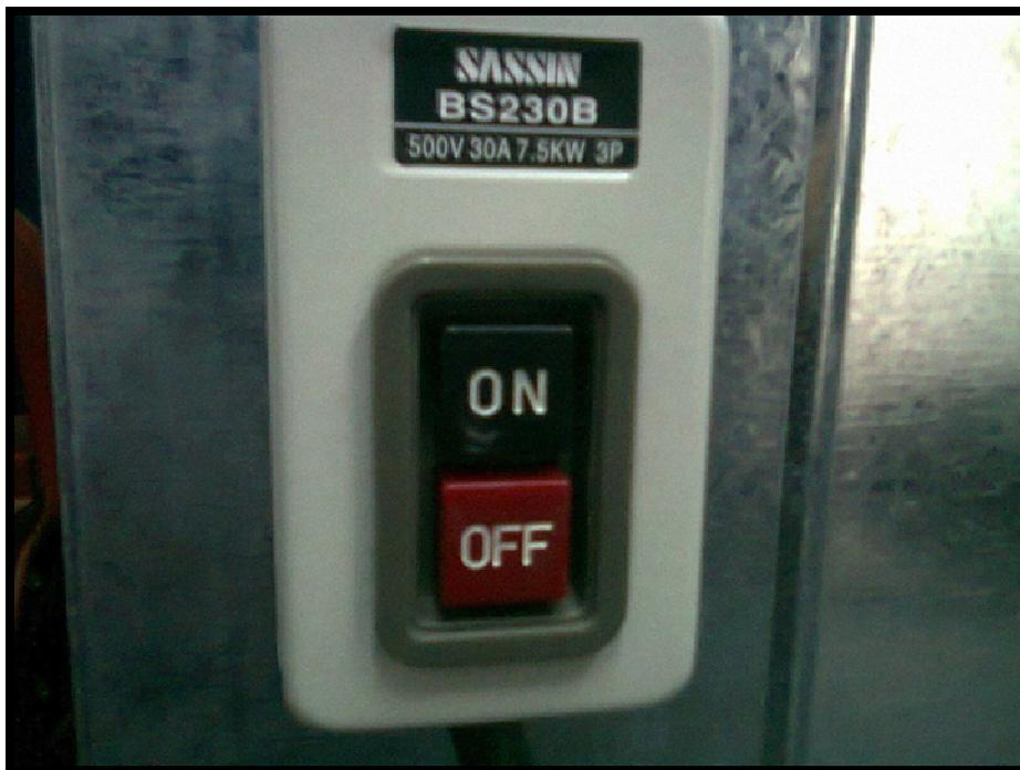
Figura E9. Especificación de la botonera de encendido
