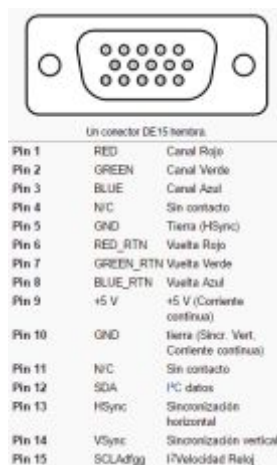
Figura 2: Distribución de pines del conector VGA
