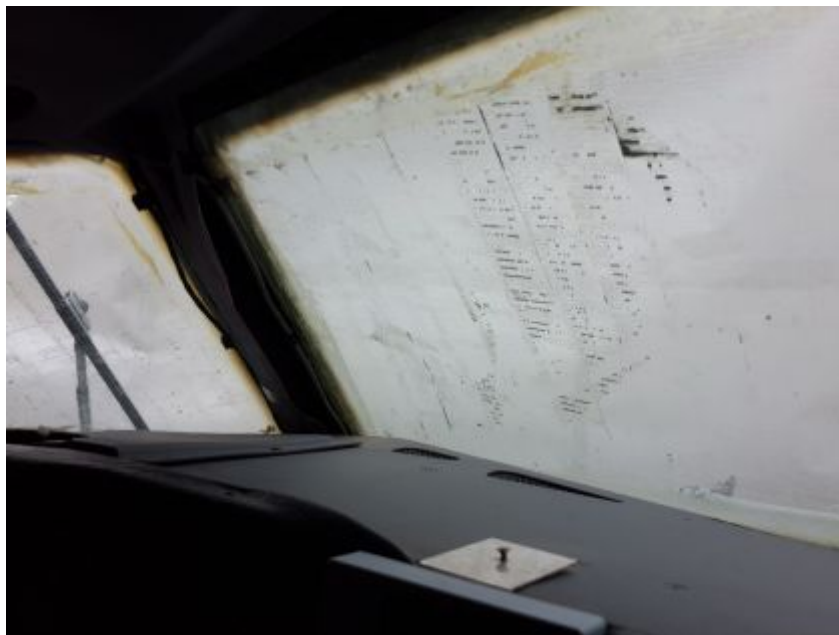
Figura 11: Parabrisas sin cinta protectora
