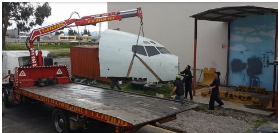
Figura 16: Proceso de mover la cabina con ayuda de una grua
