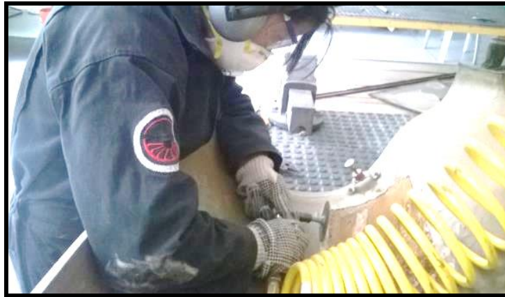
Figura 35. Corte de capa de tela dañada
