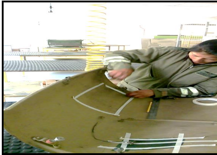
Figura 26. Colocación de la cinta adhesiva
