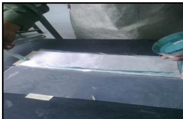
Figura 32. Untar la tela de vidrio con resina.
