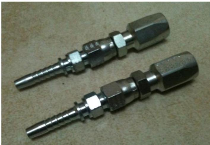
**Figura 28: Acoples del avión al simulador**
