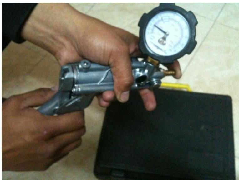
**Figura 30: Prueba de funcionamiento presión negativa**
