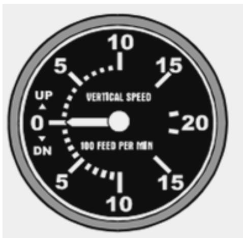
**Figura 11: Indicador de velocidad vertical**
