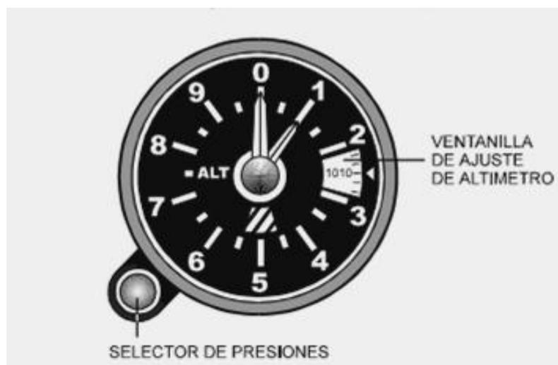
**Figura 4: Altímetro**
