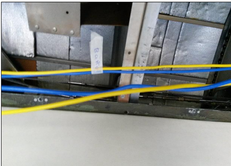
Figura 19: Instalación del cableado en el avión Fairchild FH-227J
