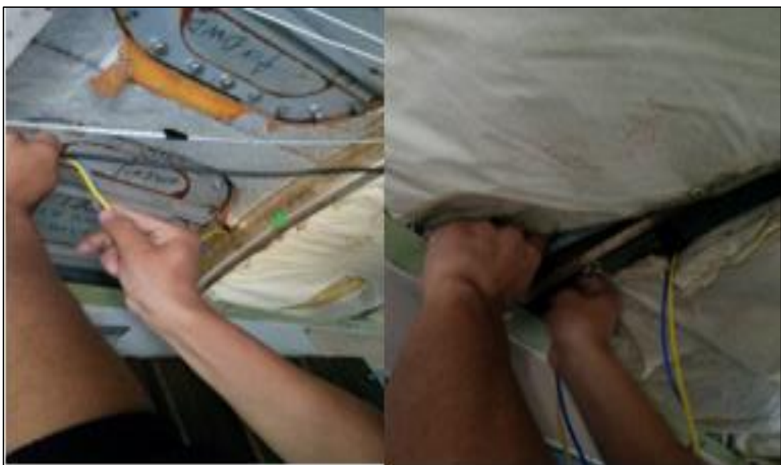
Figura 22: Instalación del cable sobre el techo del avión Fairchild FH-227J
