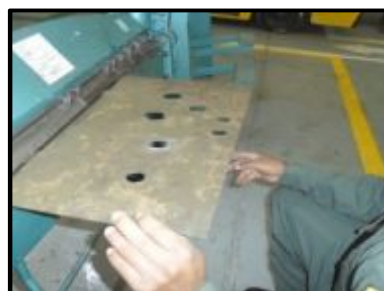
Figura 89. Proceso de doblado de la placa del panel de control.
