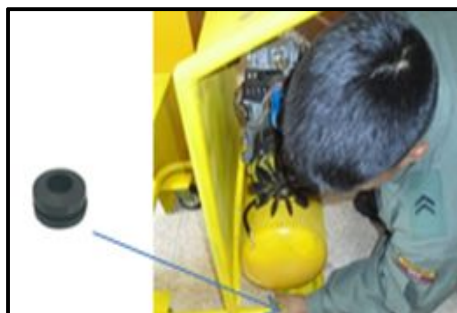
Figura 96. Montaje del compresor eléctrico
