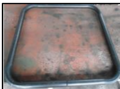
Figura 79. Proceso de doblado del tubo de hierro para la base
