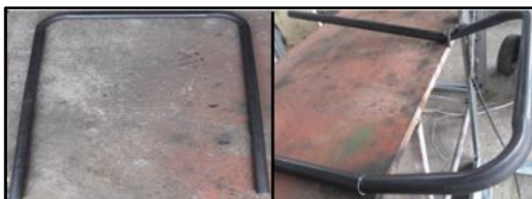
Figura 80. Proceso de doblado del tubo de hierro para la parte superior
