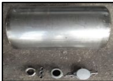
Figura 76. Montaje de los componentes del tanque
