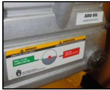
Figura 95. Colocación de los sticker en el motor eléctrico
