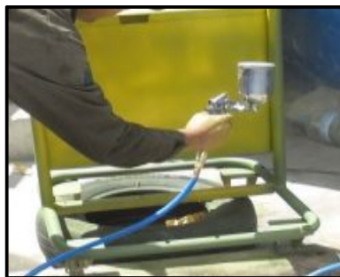
Figura 86. Proceso de aplicación de la pintura sintética al soporte
