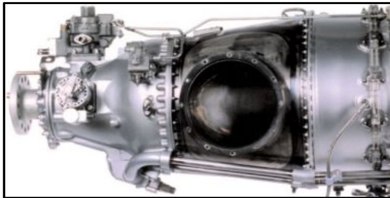
Figura 19. Sección de salida de gases del motor PT6A-42 Fuente: Manual de mantenimiento del motor PT6A-42
