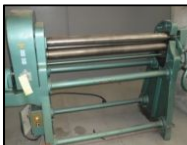
Figura 70. Proceso de rolado de la lámina de acero inoxidable
