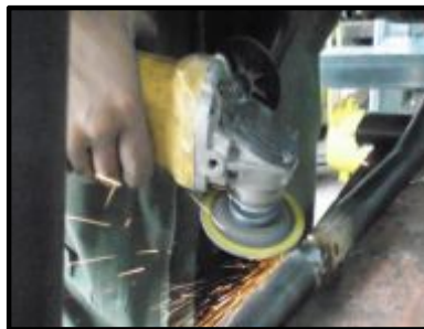
Figura 82. Proceso de pulido de las juntas del soporte
