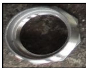
Figura 45. Brida para entrada de la solución de 2 pulgadas
