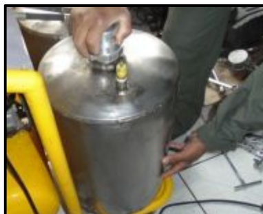
Figura 98. Montaje de los tanques para las soluciones
