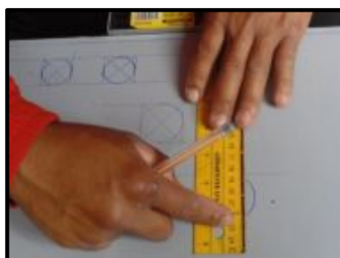
Figura 87. Proceso de trazado de la placa del panel de control
