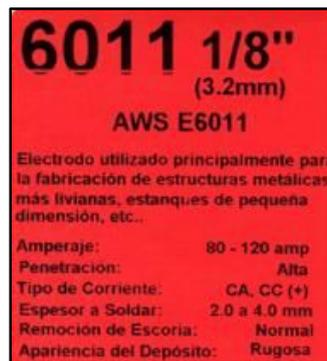
**Figura 59.** Especificación electrodo 6011
