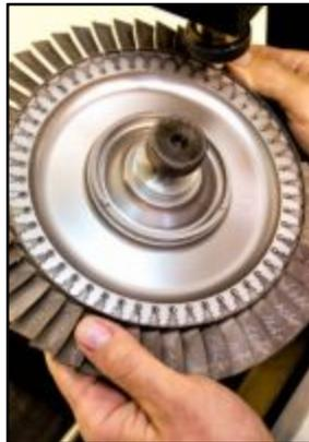
**Figura 13.** Remachado de los álabes en la turbina
