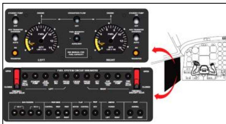
**Figura 33.** Panel de mando y control del sistema de combustible
