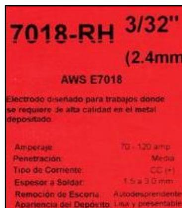
**Figura 60.** Especificación electrodo 7018
