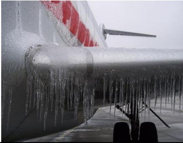
La formación de hielo sobre la superficie de las aeronaves recibe el nombre de engelamiento y es la principal causa de siniestralidad aérea en el mundo, por encima de la turbulencia en sus diferentes variantes.
