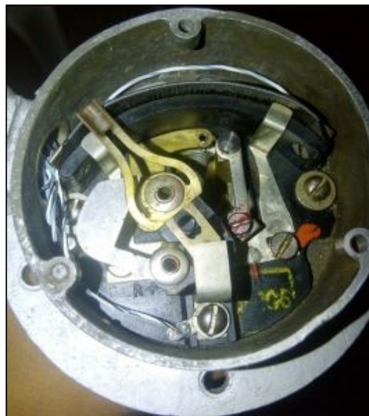
Figura 31. Mecanismo interno del transmisor de combustible.
