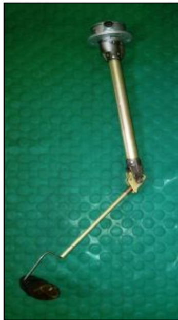
Figura 30. Conjunto de transmisor y flotador de combustible.
