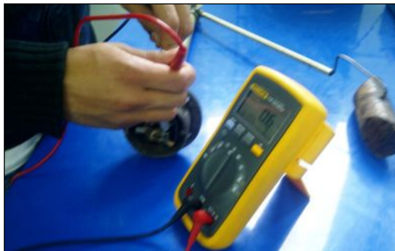
Figura 32. Prueba de funcionamiento del transmisor de combustible.
