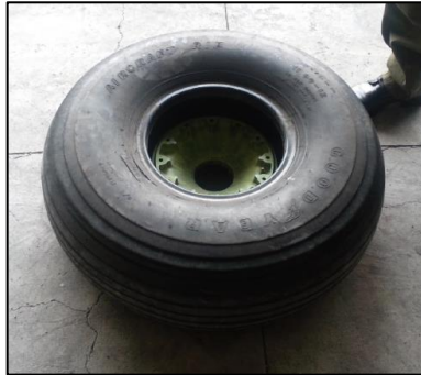
Figura 56. Mitad de la rueda en el interior del neumático
