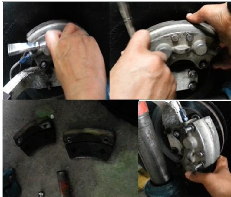
Figura 75. Desmontaje de la placa posterior de freno
