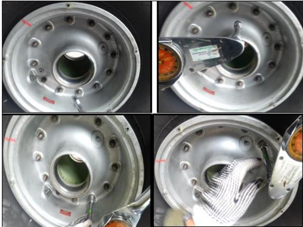
Figura 60. Torque los pernos
