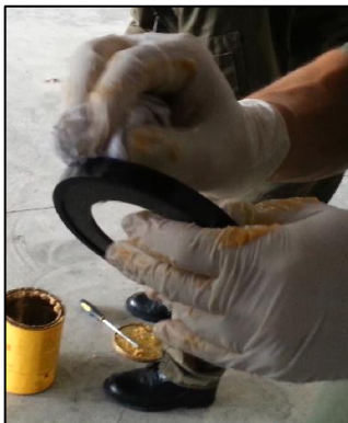
Figura 58. Lubricación de los elementos del conjunto de ruedas
