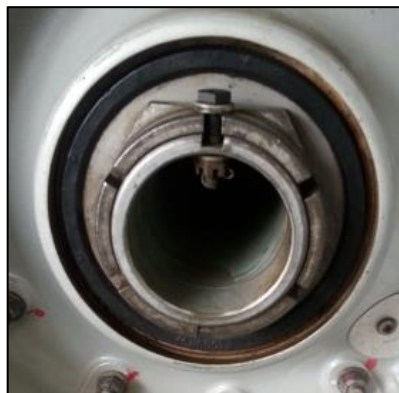
Figura 71. Tuerca de la rueda seguridad asegurada
