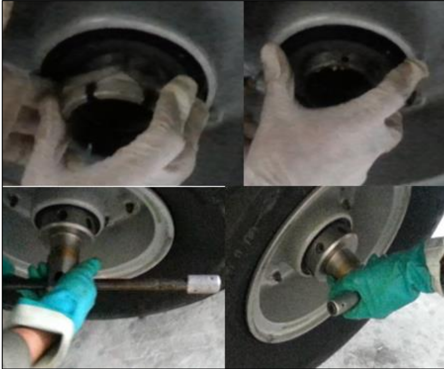
Figura 69. Ajuste y desajuste la tuerca del eje
