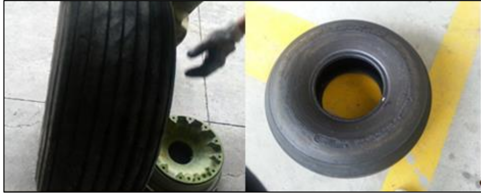
Figura 50. Remoción del neumático
