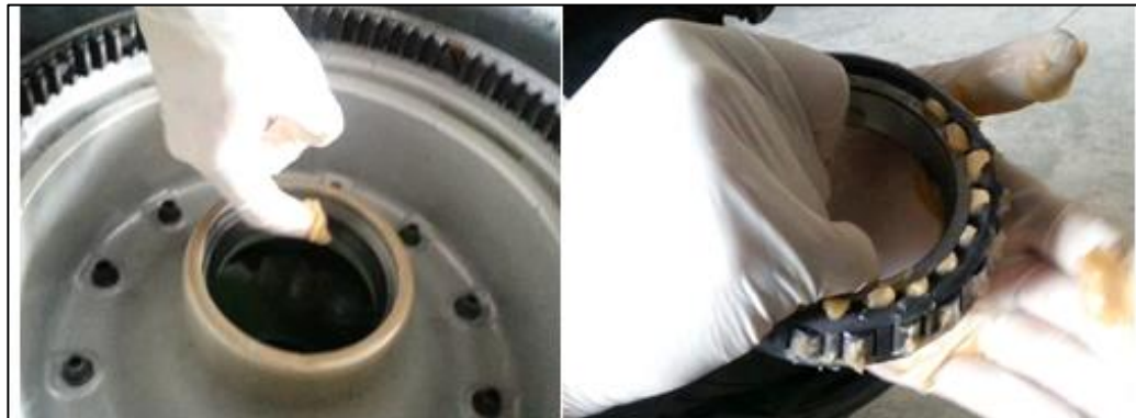
Figura 64. Lubricación de los componentes de rodamiento
