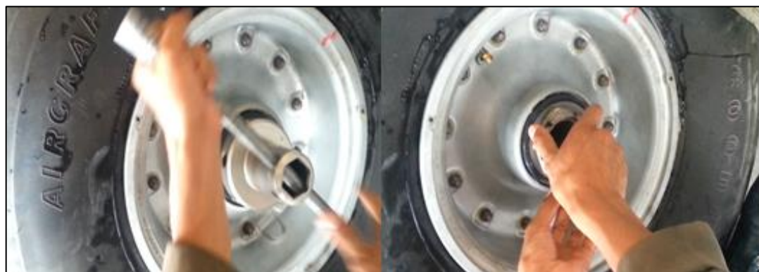
Figura 38. Desmontaje de la tuerca bloqueadora del eje con la herramienta 101-932-01.01
