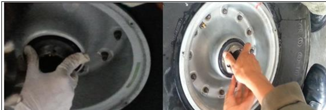
Figura 39. Desmontaje de los seguros, pernos y guardapolvos
