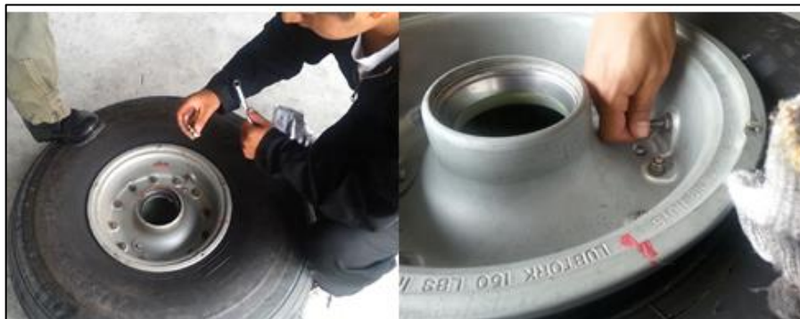
Figura 45. Liberando presión de los neumáticos
