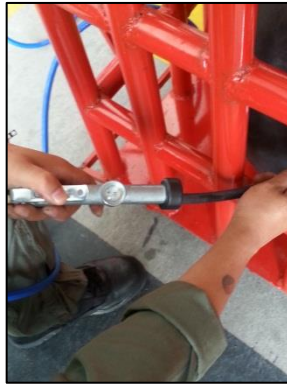
Figura 63. Inflado del neumático a 40 PSI
