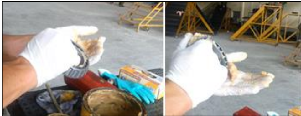
Figura 52. Lubricación de los rodamientos cónicos
