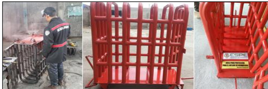
Figura 99. Pintado de la estructura
