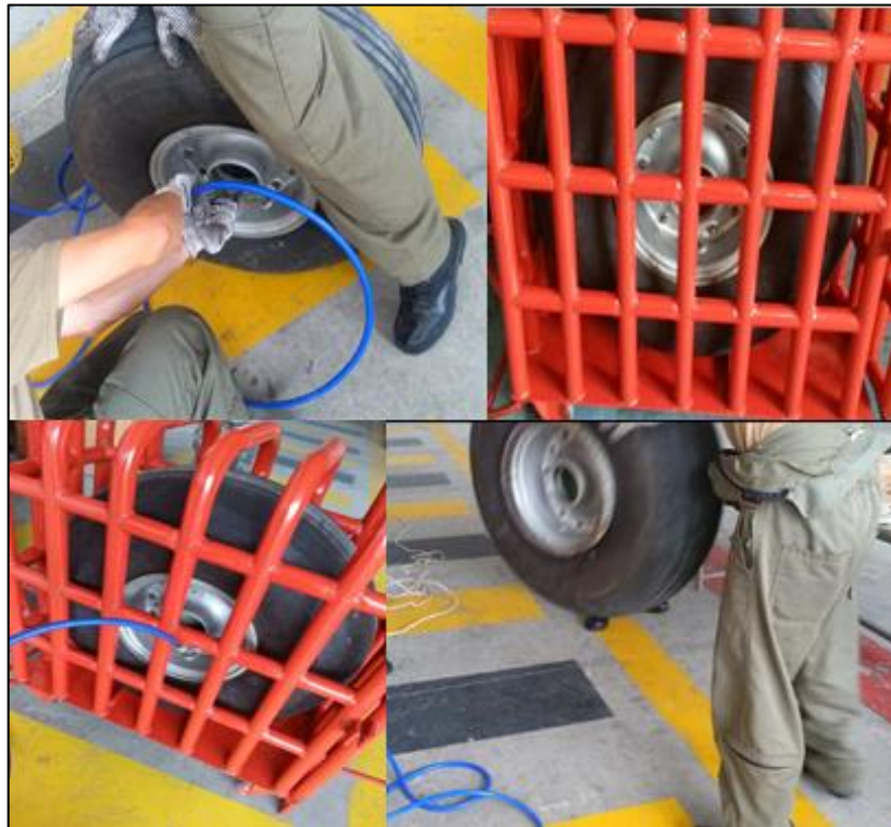
Figura 62. Procedimiento de inflado para asentar los talones del neumático
