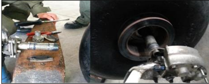
Figura 77. La rueda sobre el eje del tren de aterrizaje
