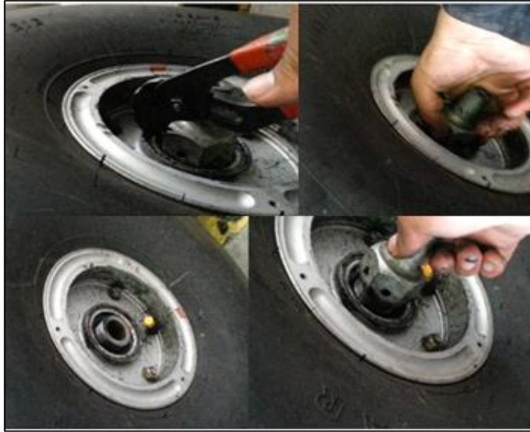
Figura 74. Desmontaje del cotter pin y tuerca del eje
