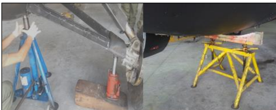
Figura 36. Ubicación de gatas hidráulicas
