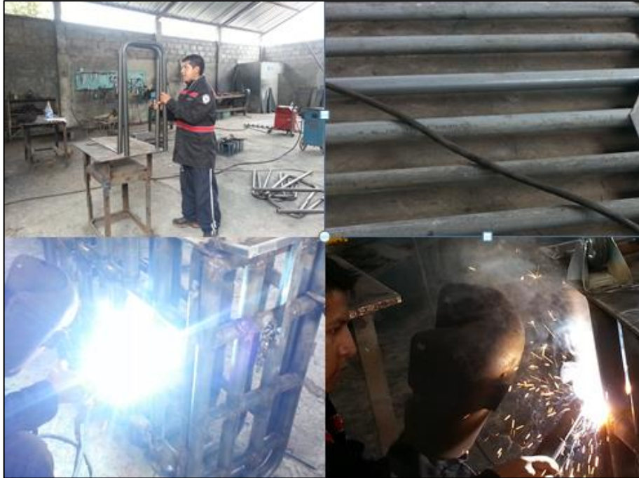
Figura 96. Formación de la estructura por medio de suelda electrica
