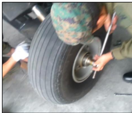
Figura 70. Reajuste de la tuerca de la rueda
