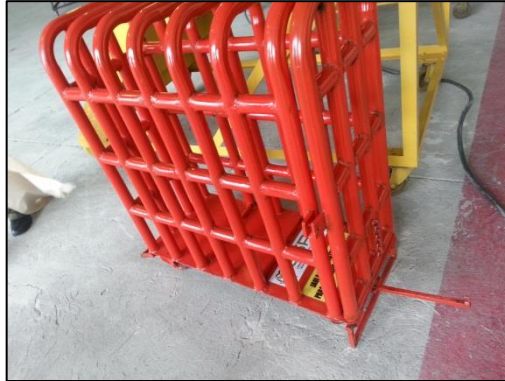
Figura 61. Jaula de protección para el inflado de neumáticos
