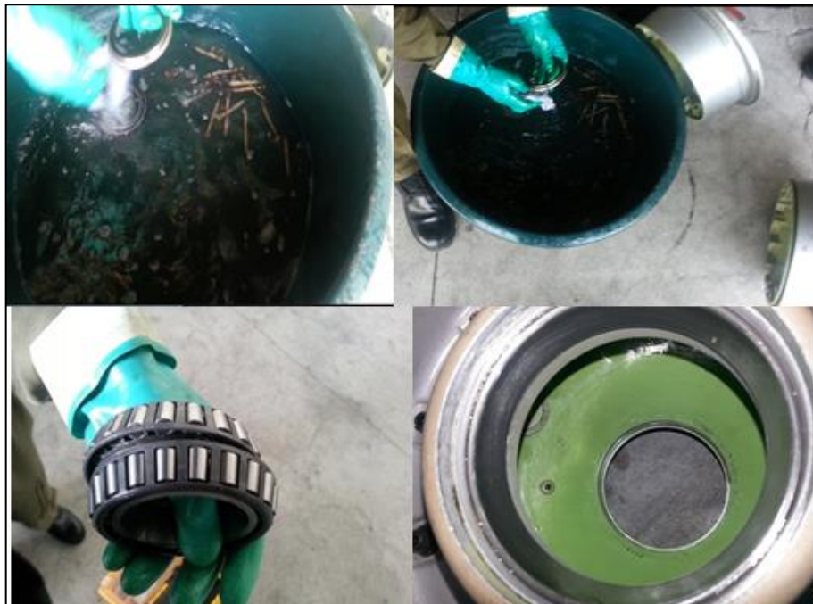
Figura 51. Limpieza de elementos por inmersión.
