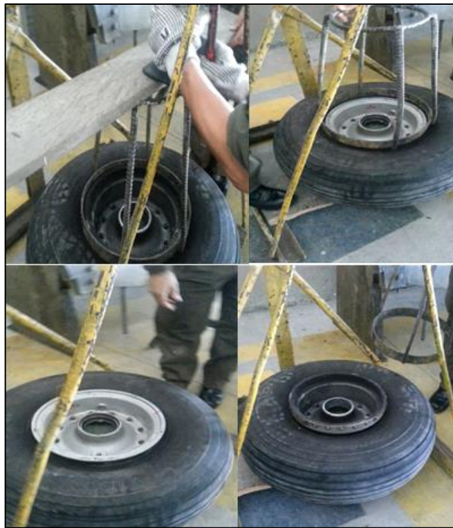
Figura 48. Extracción de ruedas en el mecanismo de extractor de ruedas
