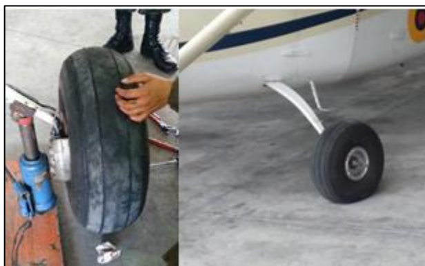
Figura 80. Retirar las gatas de la aeronave
