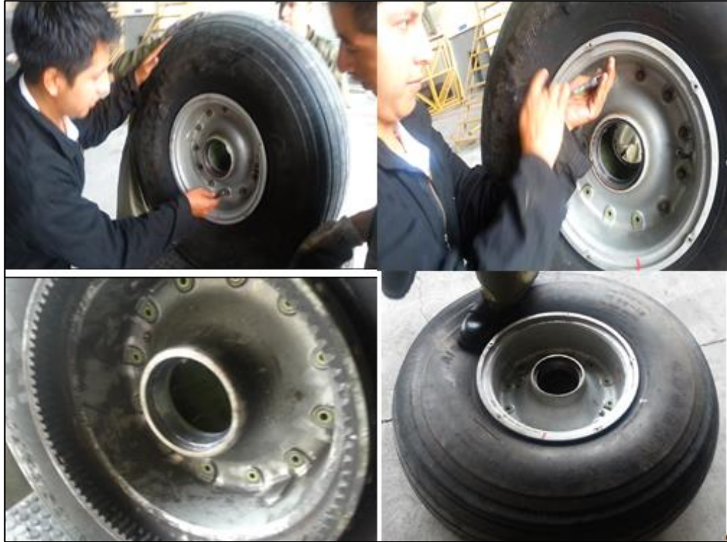
Figura 49. Remoción de tuercas del conjunto de ruedas
