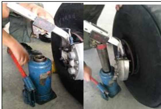
Figura 72. Aeronave puesta en gatas
