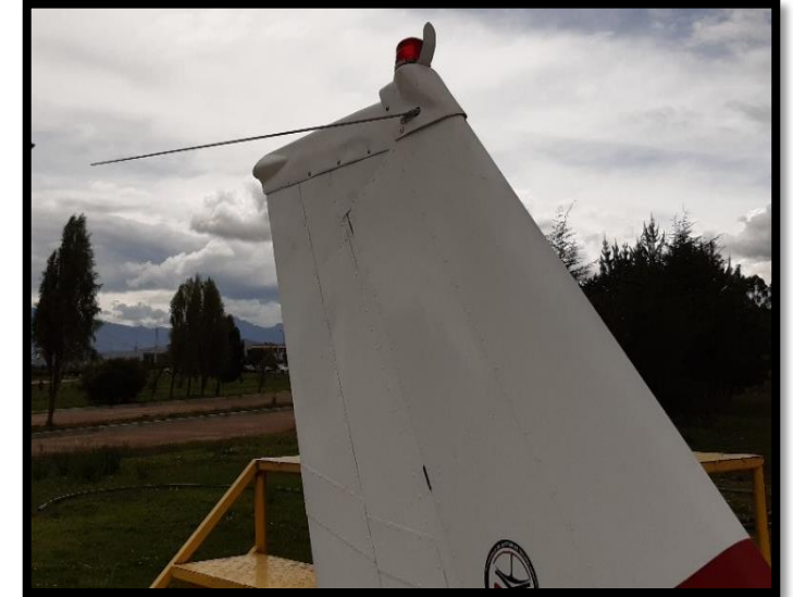
Antena VOR instalada en el estabilizador vertical
