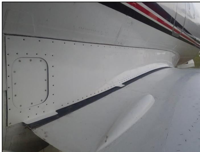
**Figura 20.** Instalación de carenados.
