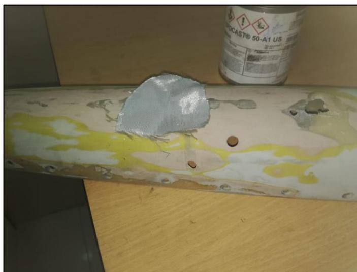
**Figura 23.** Fibra de vidrio BMS 9-3; Tipo D, H-2.
