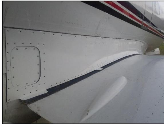
**Figura 1.** Carenado derecho ala-fuselaje.
