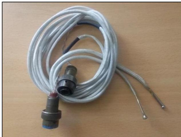
**Figura 9.** Termopares.
