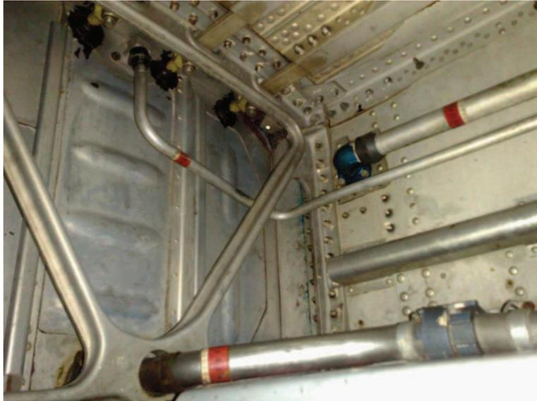
**Figura 3.7:** Líneas de combustible en el compartimiento del tren principal
