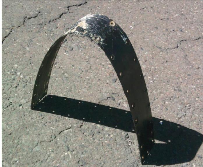
**Figura 3.3:** Placa removida del borde de ataque del ala izquierda
