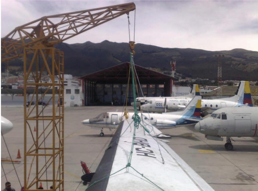
**Figura 3.11:** Proceso de desmontaje del ala externa
