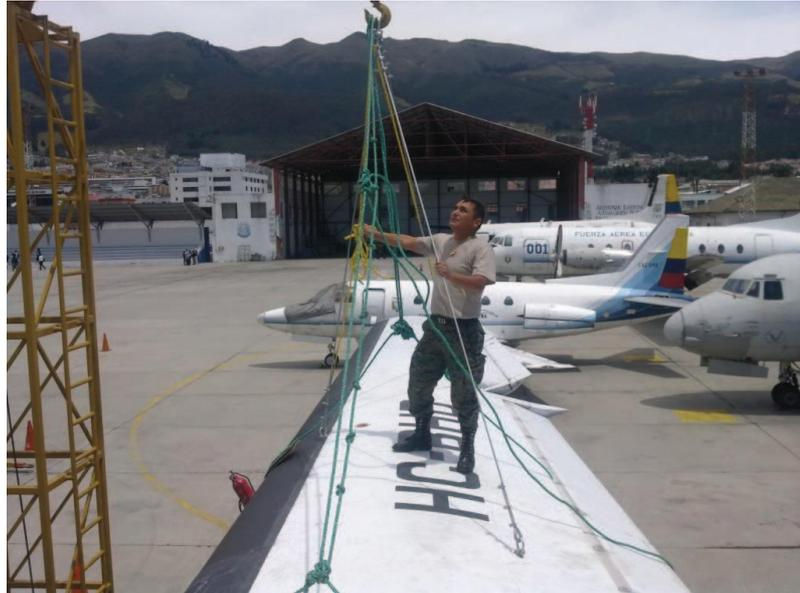
**Figura 3.10:** Sujeción de los tres puntos de izaje del ala externa
