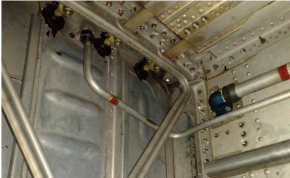
**Figura 3.16:** Placas de los largueros y ajustes angulares vista interior
