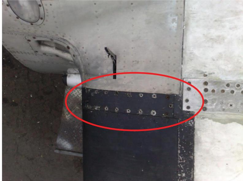
**Figura 3.2:** Placa del borde de ataque del ala
