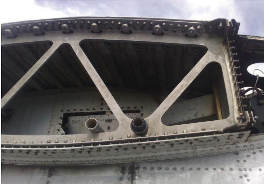
**Figura 3.17:** Placas de los largueros y ajustes angulares vista exterior
