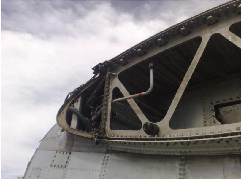
**Figura 3.20:** Desconexiones aseguradas del ala central
