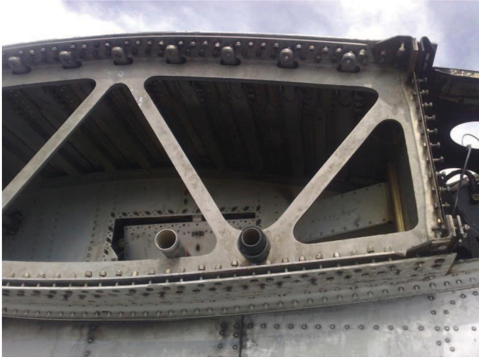
**Figura:** Placas y ángulos de empalme
