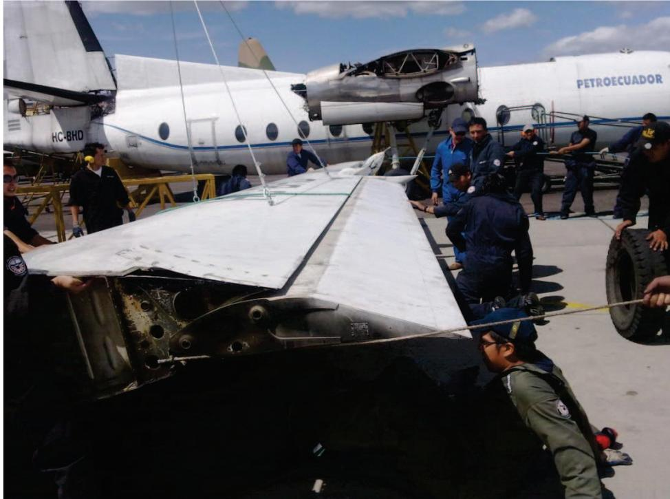
**Figura 3.23:** Colocación de neumáticos como soporte del ala
