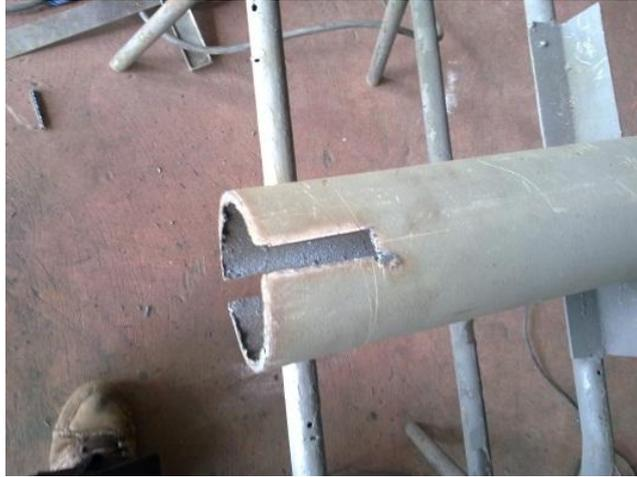
**FIGURA 3.8.8:** Destajes en las columnas
