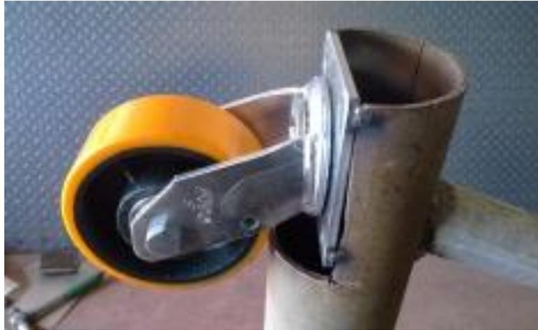
**FIGURA 3.8.13:** Puntos de suelda entre las ruedas y la estructura
