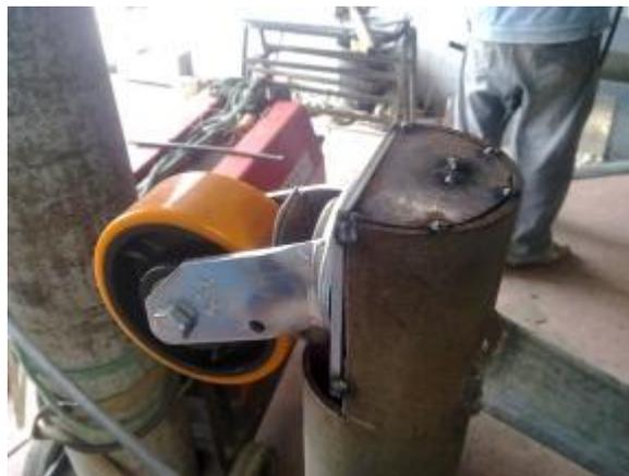
**FIGURA 3.8.14:** Cubiertas soldadas a la estructura
