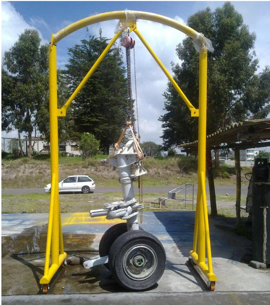
**FIGURA 3.11:** Conjunto terminado del Soporte y el tren de aterrizaje
