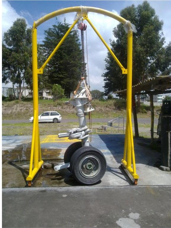
**FIGURA 3.8.18:** Estructura terminada y con el tren de aterrizaje montado
