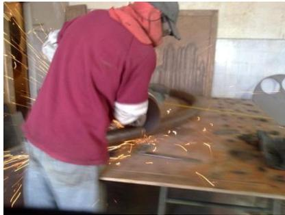
**FIGURA 3.8.4:** Corte de parte superior del soporte
