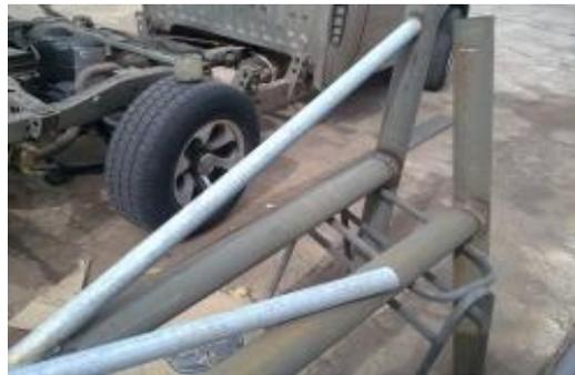
**FIGURA 3.8.11:** Soportes soldados a la estructura
