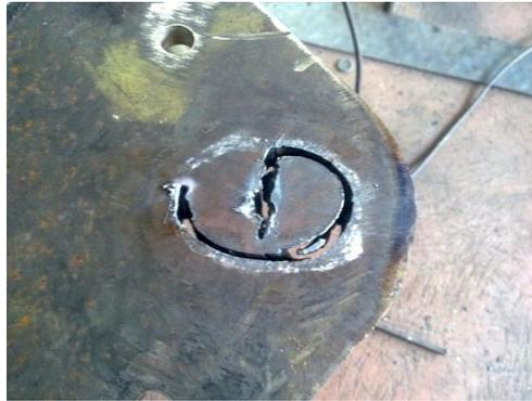
**FIGURA 3.8.16:** Orificio para la oreja del tecle
