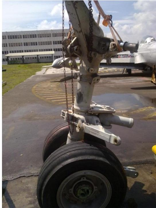
**FIGURA 3.9:** Limpieza de la superficie del tren de aterrizaje
