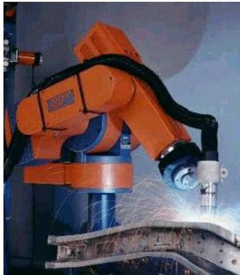
**FIGURA 2.23:** Cortadora de plasma mecánica
