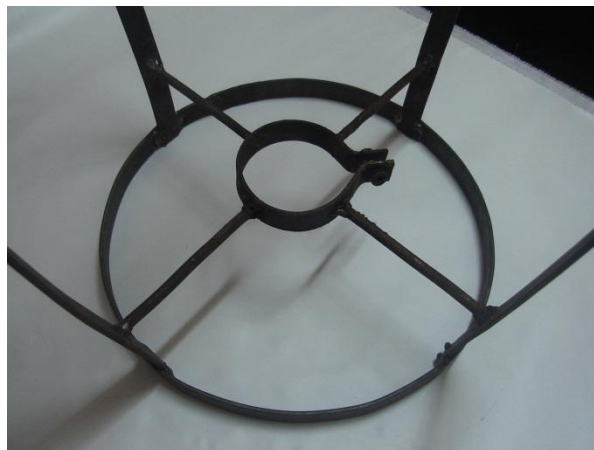
FIGURA 3.14: Soporte del ventilador
