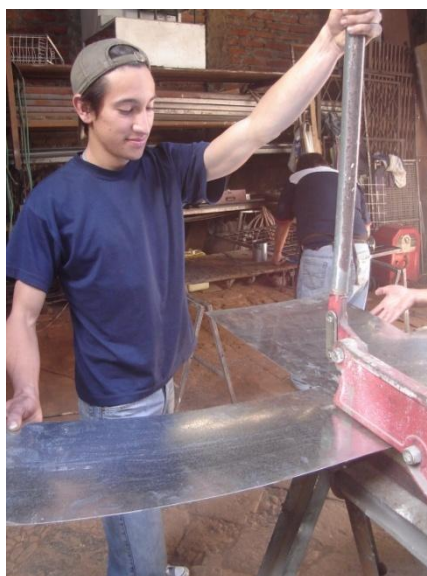
FIGURA 3.21: Cortado de las planchas de Tol Fuente: Investigación de Campo
