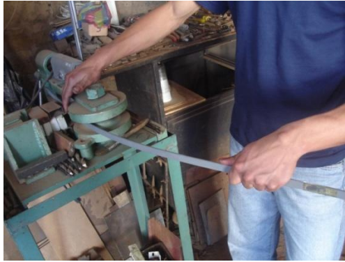
FIGURA 3.7: Doblado de las barrillas
