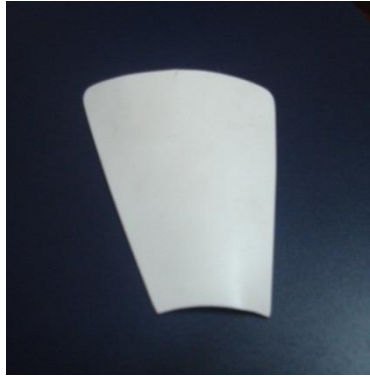
FIGURA ANEXO D 1: ÁLABE EN BUEN ESTADO
