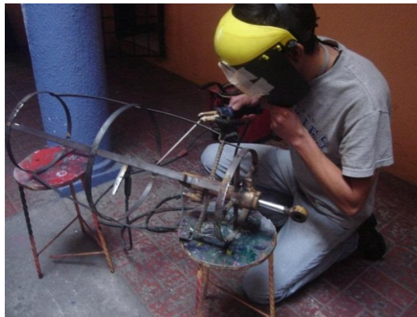
FIGURA 3.11: Soldadura de la estructura principal Fuente: Investigación de Campo
