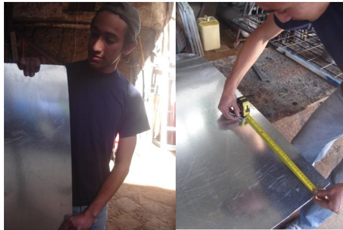
FIGURA 3.20: Planchas de Tol, medido y trazado Fuente: Investigación de Campo
