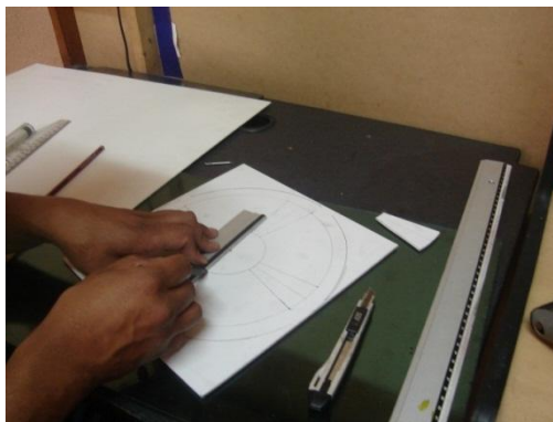
FIGURA 3.1: Medida y trazado de los álabes en plástico PVC Fuente: Investigación de Campo
