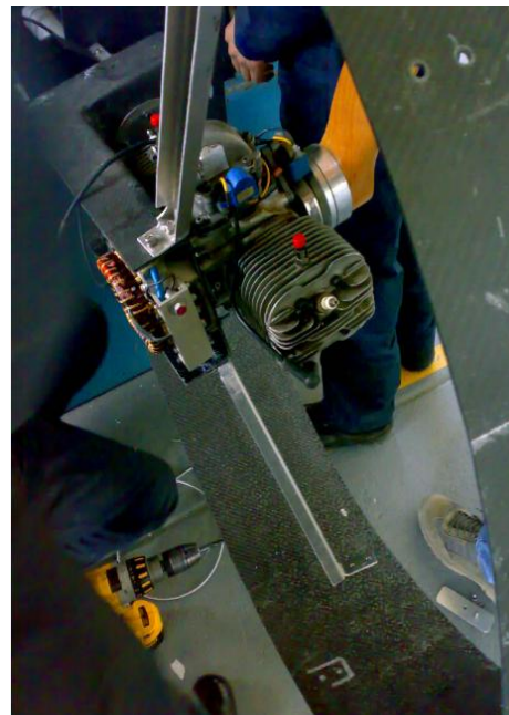
Figura 3.37: Ubicación sensor de RPM
