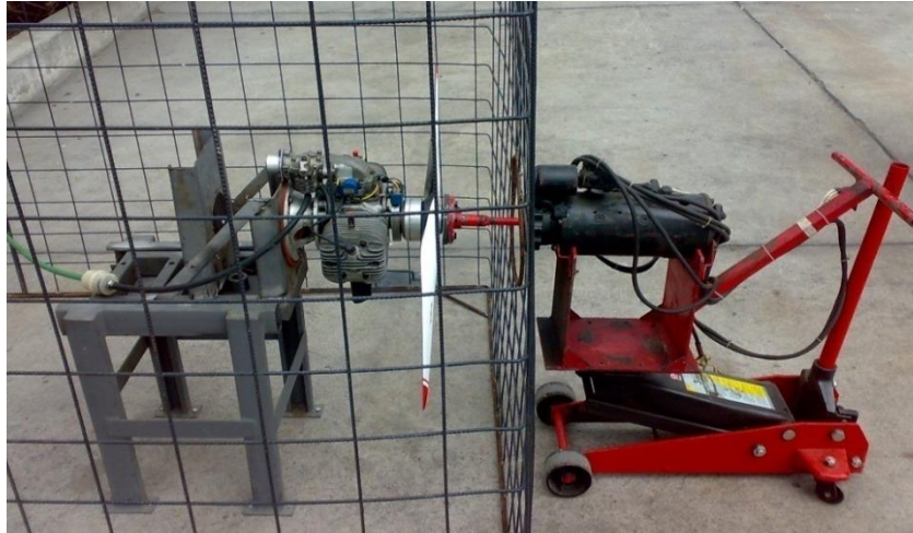
Figura 3.21: Motor de arranque funcionando
