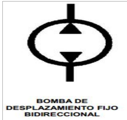
Figura 48. Símbolo de Bomba de Desplazamiento fijo bidireccional.
