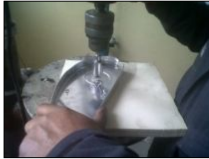
Figura 70. Perforación del orificio de aligeramiento
