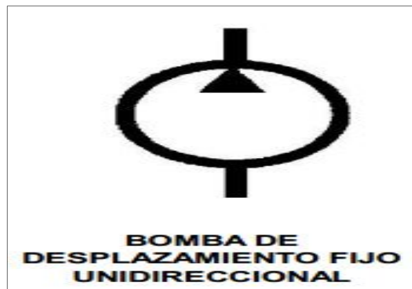
Figura 47. Símbolo de Bomba de Desplazamiento Fijo unidireccional.
