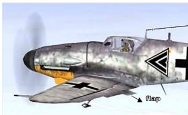
Figura 4. Los flaps o alerones de sustentación
