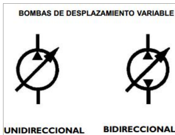
Figura 49. Símbolos de Bomba de Desplazamiento Variable.
