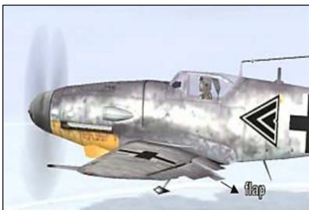
Figura 5. Los flaps o alerones de sustentación
