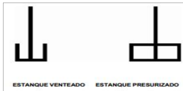
Figura 42. Estanque venteado y presurizado
