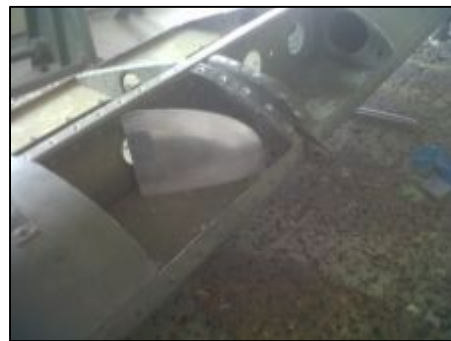
Figura 73. Construcción de las costillas falsas
