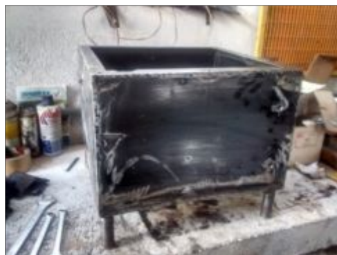
Figura 79. Lijado del reservorio
