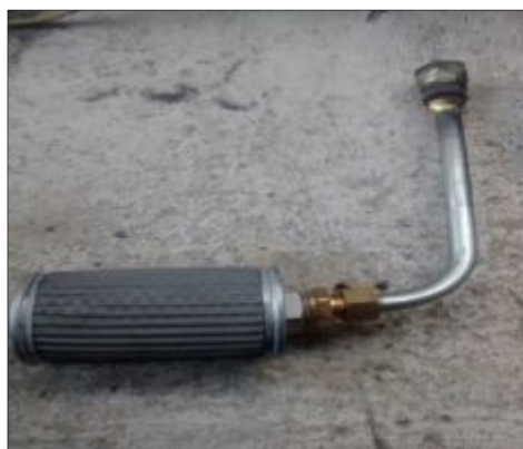
Figura 83. Colocaci3n del filtro
