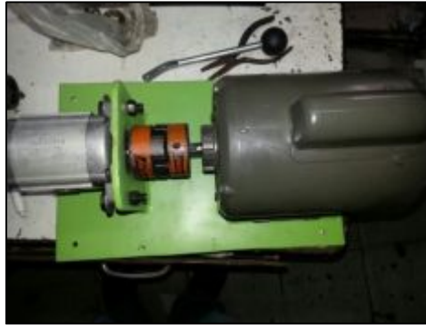
Figura 86. Acoplamiento motor bomba
