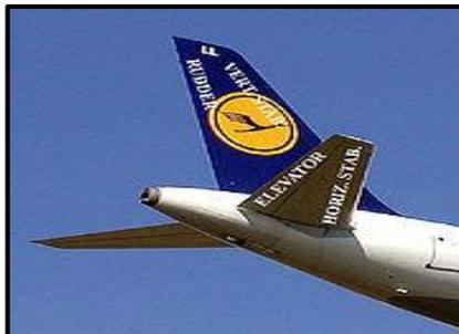
**Figura 29.** Estabilizador móvil
