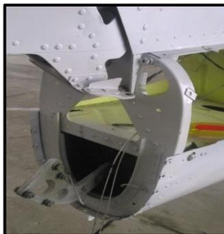
**Figura 69.** Chequeo de cables en la dirección correcta
