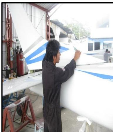
**Figura 64.** Instalación del estabilizador vertical
