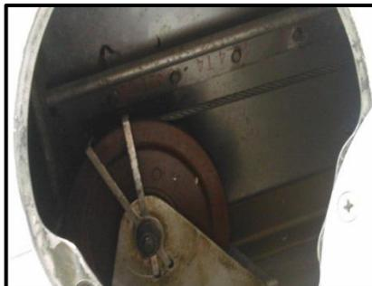
**Figura 59.** Limpieza de cables y poleas
