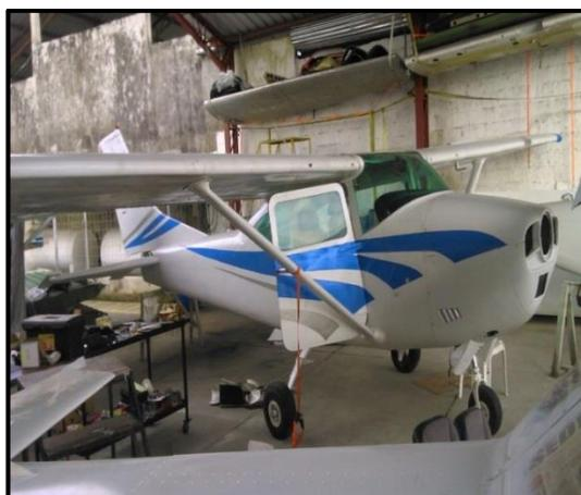
**Figura 73.** Instalación final del ala y empenaje
