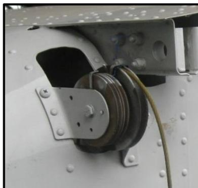
**Figura 61.** Limpieza de cables y poleas
