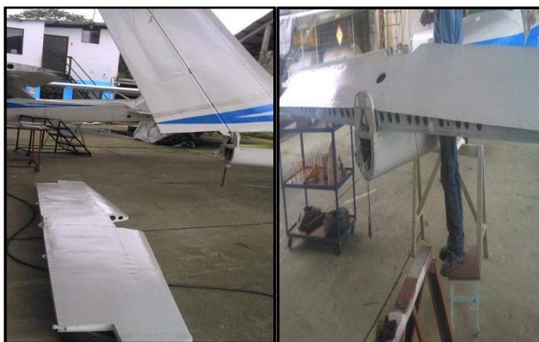
**Figura 65.** Instalación del estabilizador horizontal
