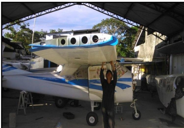
**Figura 57.** Instalación del montante
