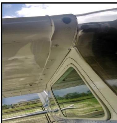
**Figura 63.** Instalación del carenaje del ala –estructura
