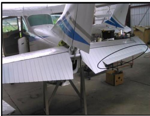
**Figura 72.** Instalación de la aleta de compensación
