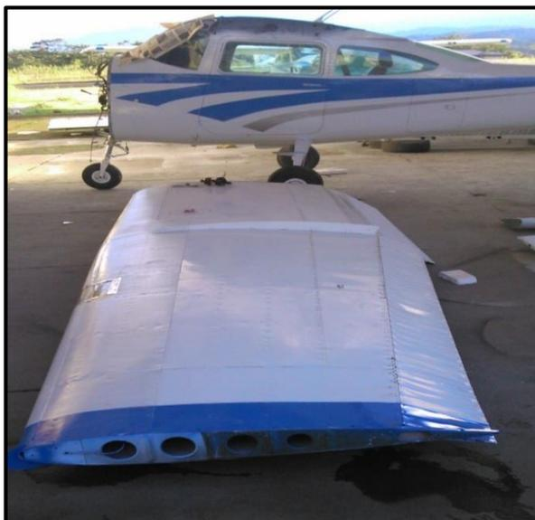
**Figura 56.** Posición del ala para el montaje
