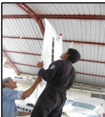
**Figura 70.** Instalación del Rudder
