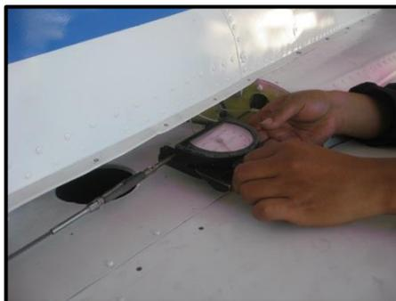
**Figura 71.** Tensión de los cables del Rudder
