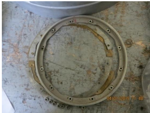
Figura 55. Remoción del anillo de paso fino.
