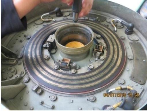
Figura 39. Remoción de los switches de contacto y tapón de balance.
