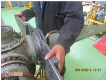
Figura 48. Herramienta especial para remover las palas (TL4488).
