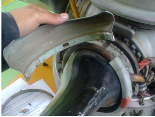
Figura 37. Desmontaje del blindaje de las palas.
