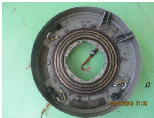
Figura 43. Alojamiento de anillo deslizante removido.
