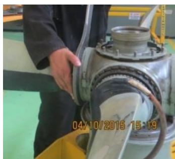
Figura 50. Colocación de la llave de anillo en el rodamiento de pala.
