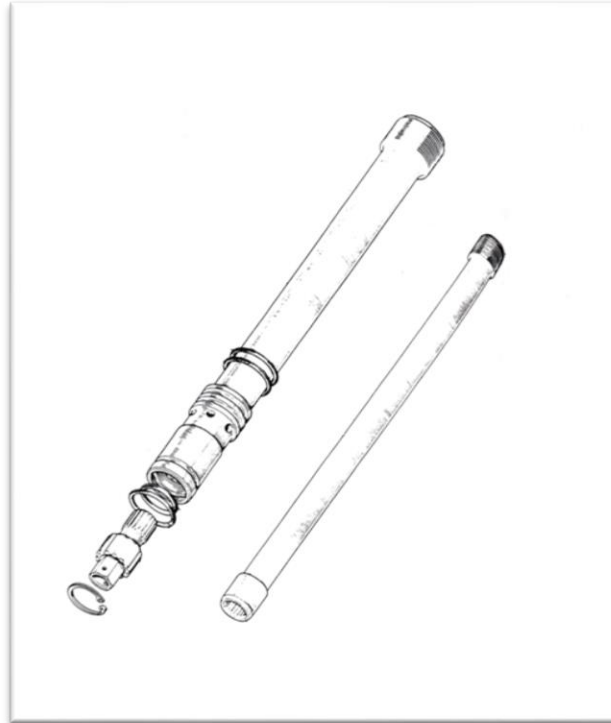
Figura 8. Tubos de aceite exterior e interior.
