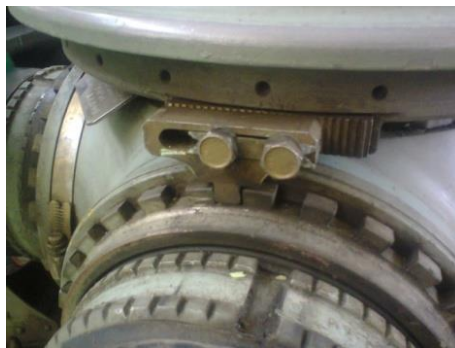
Figura 45. Bloqueo del rodamiento de pala y placa dentado del cilindro.
