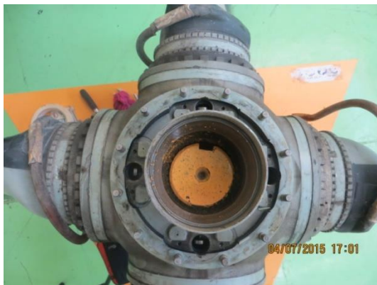
Figura 42. Remoción de alojamiento de anillo deslizante.
