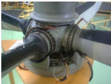
Figura 46. Remoción del bloqueo de la pala.
