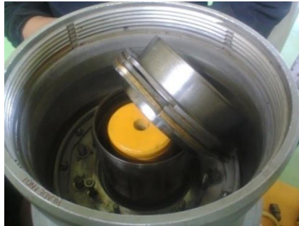
Figura 56. Remoción de la parada de paso fino de crucero, vuelo y camisa del pistón.
