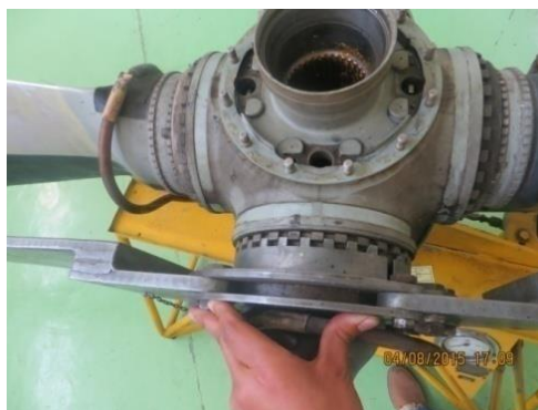
Figura 47. Colocación de la herramienta en el rodamiento de pala.
