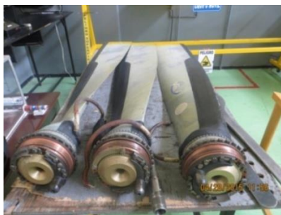
Figura 51. Palas removidas desde el cubo.
