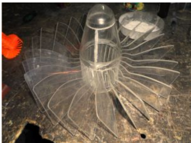
Figura 36. Termo formado del acrílico.
