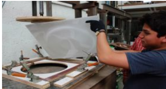
Figura 21. Proceso de termo formado del acrílico.
