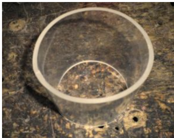
Figura 37. Termo formado del acrílico.
