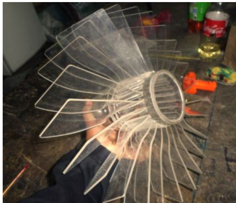
Figura 35. Corte de acrílico en laser.
