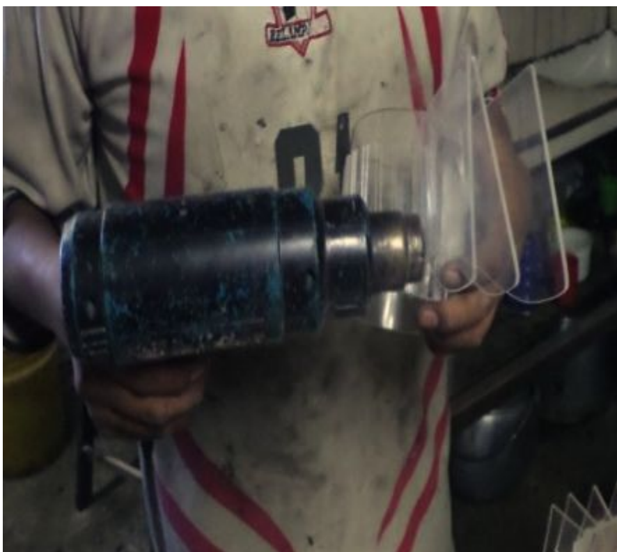
Figura 32. Termo formado del alabe del FAN.
