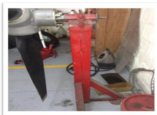
**Figura 1:** Banco de pruebas para el chequeo de paso de ángulo de la pala
