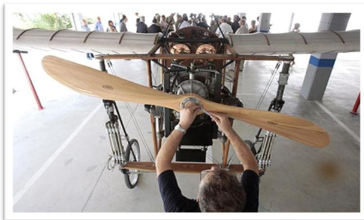
**Figura 8:** Hélices de paso ajustable en tierra
