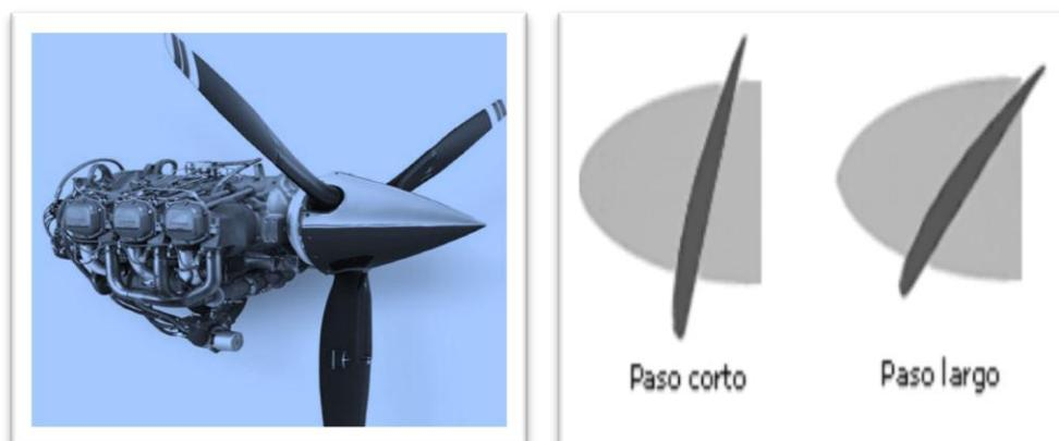
**Figura 9:** Hélices de paso variable
