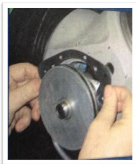
**Figura 41:** Empaque del cilindro
