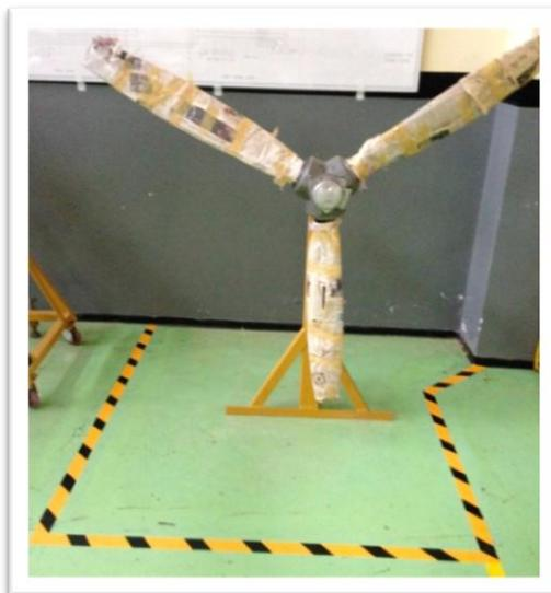
**Figura 45:** Hélice instalada en el banco de pruebas
