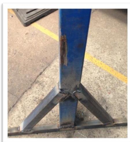
**Figura 16:** Remate de puntos con suelda eléctrica
