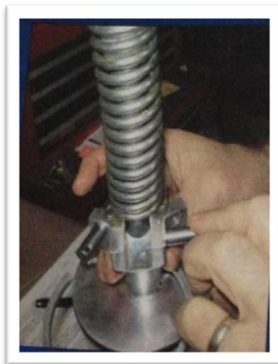
**Figura 38:** Colocación de pines en el pistón
