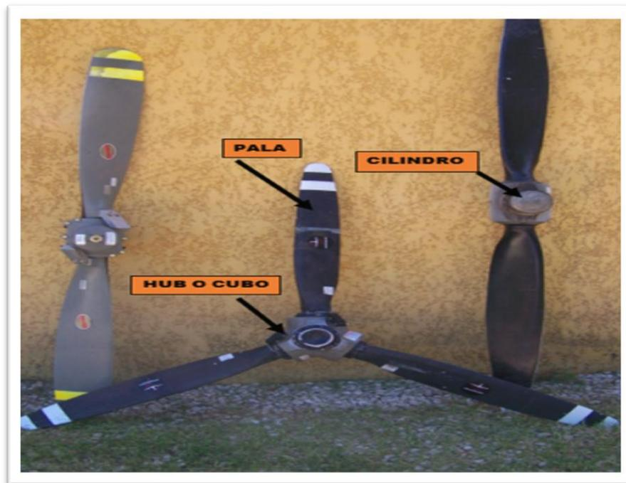
**Figura 3:** Partes de una Hélice
