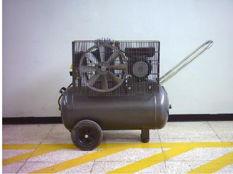
Fig. 2.5 Compresor de aire
