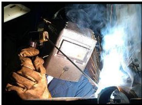
**Figura 17: Soldadura por arco**
