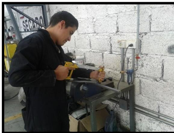
**Figura 25: Corte y doblado de láminas**
