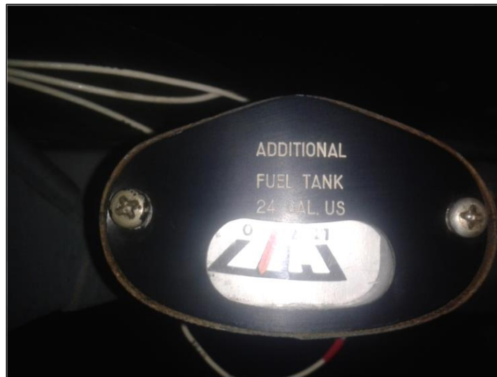
Figura 3. 28 Rehabilitación de la falla de nivel del indicador
