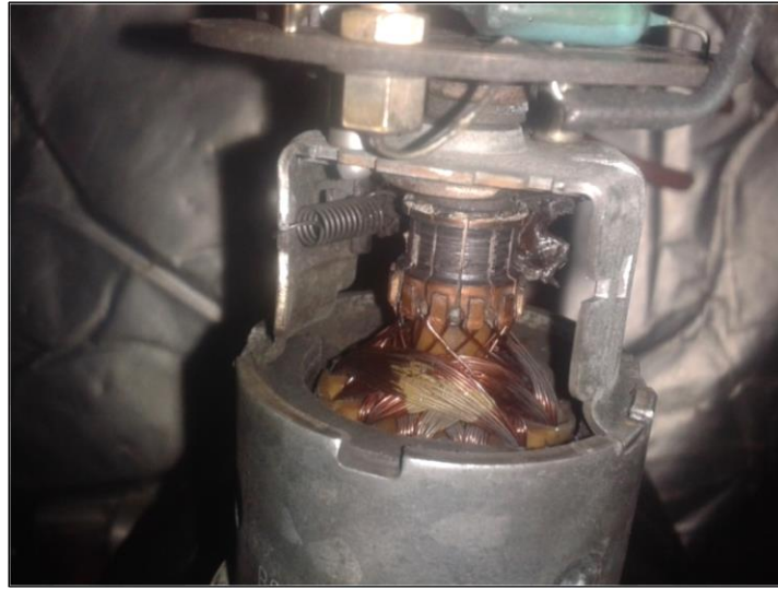
Figura 3. 13 Cambio de contactos de carbón y limpieza de la bobina de la bomba
