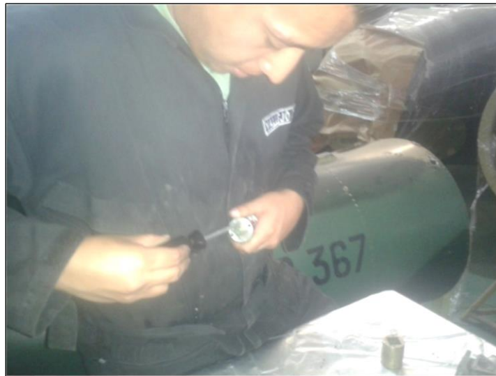
Figura 3. 12 Limpieza de los contactos y colocación de masas en el manocontactor
