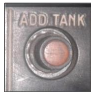
Figura 2. 26 Luz de transferencia de combustible
