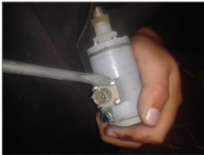
Figura 3. 9 Limpieza y colocación de terminales de masa del manocontactador
