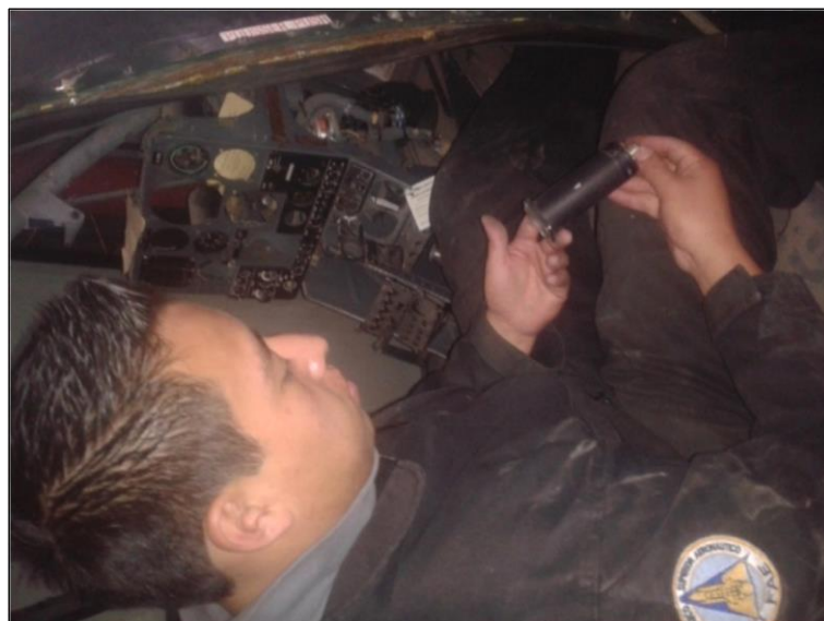
Figura 3. 18 Colocación del indicador de nivel de combustible primario
