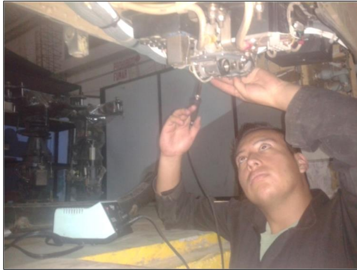
Figura 3. 14 Suelda con estaño del cableado eléctrico en el corazón eléctrico
