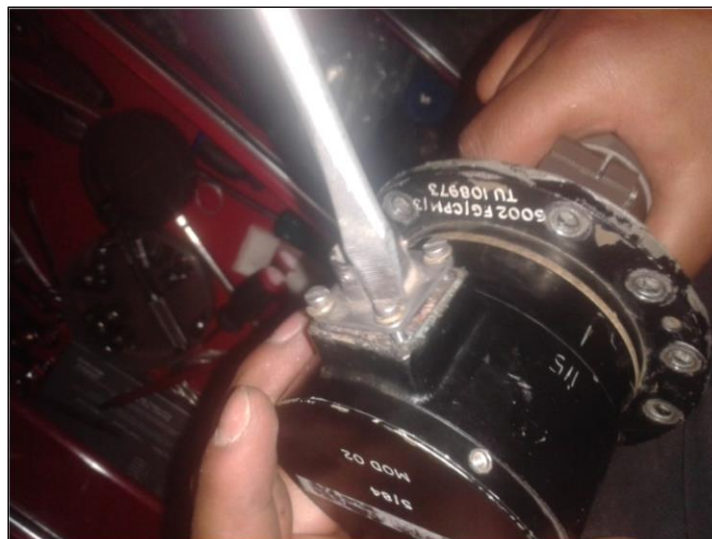
Figura 3. 8 Limpieza de los contactos sulfatados del transmisor de nivel de combustible
