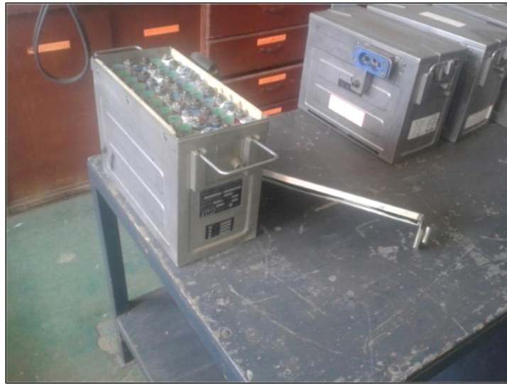
Figura 3. 23 Colocación de las partes desmontadas y carga de la batería
