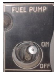
Figura 2. 23 Interruptor de la bomba de cebado
