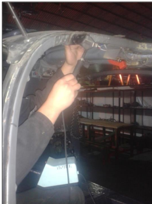
Figura 3. 16 Suelda de los terminales de masa y de corriente del indicador
