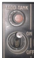
Figura 2. 24 Interruptor de la bomba de transferencia
