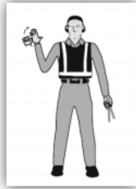
**Figura 10. Suelte los frenos**
