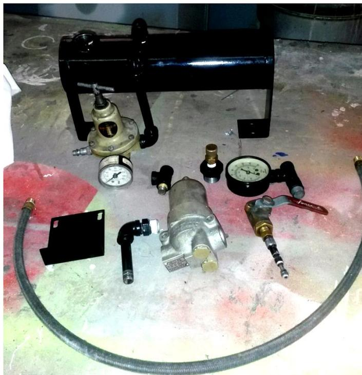
**Figura 50.** Elementos del sistema de aire y combustible
