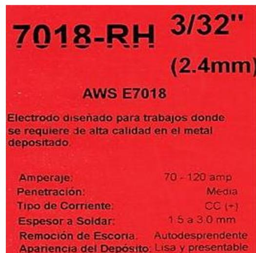
**Figura 38.** Especificación electrodo 7018
