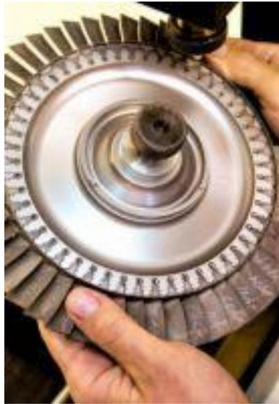
**Figura 12.** Remachado de los álabes en la turbina
