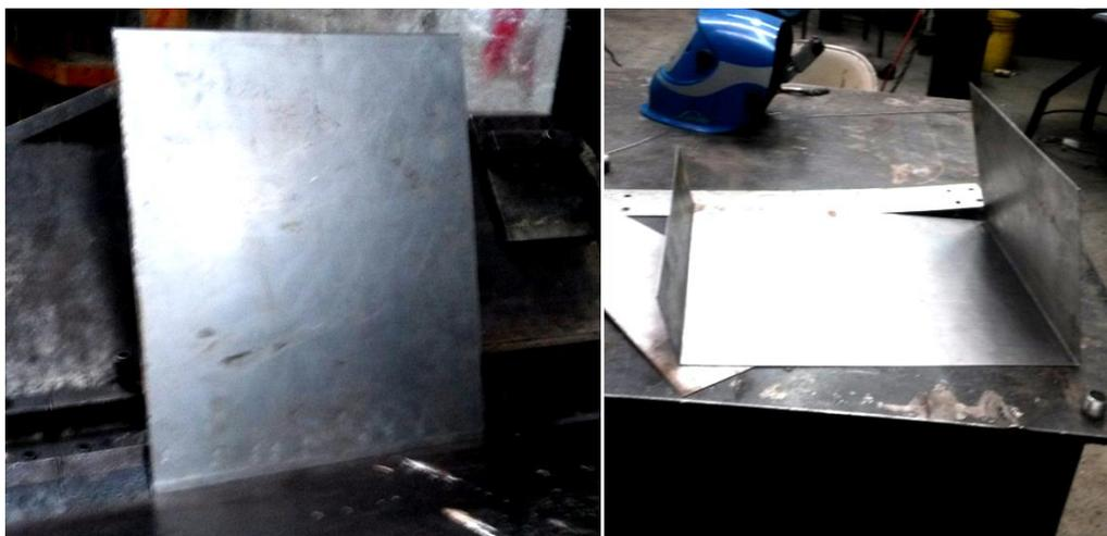
**Figura 47.** Doblado de la lámina de tol
