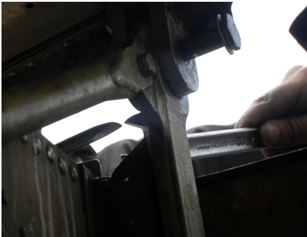
Figura 3.17: Colocación de la arandela y la tuerca
