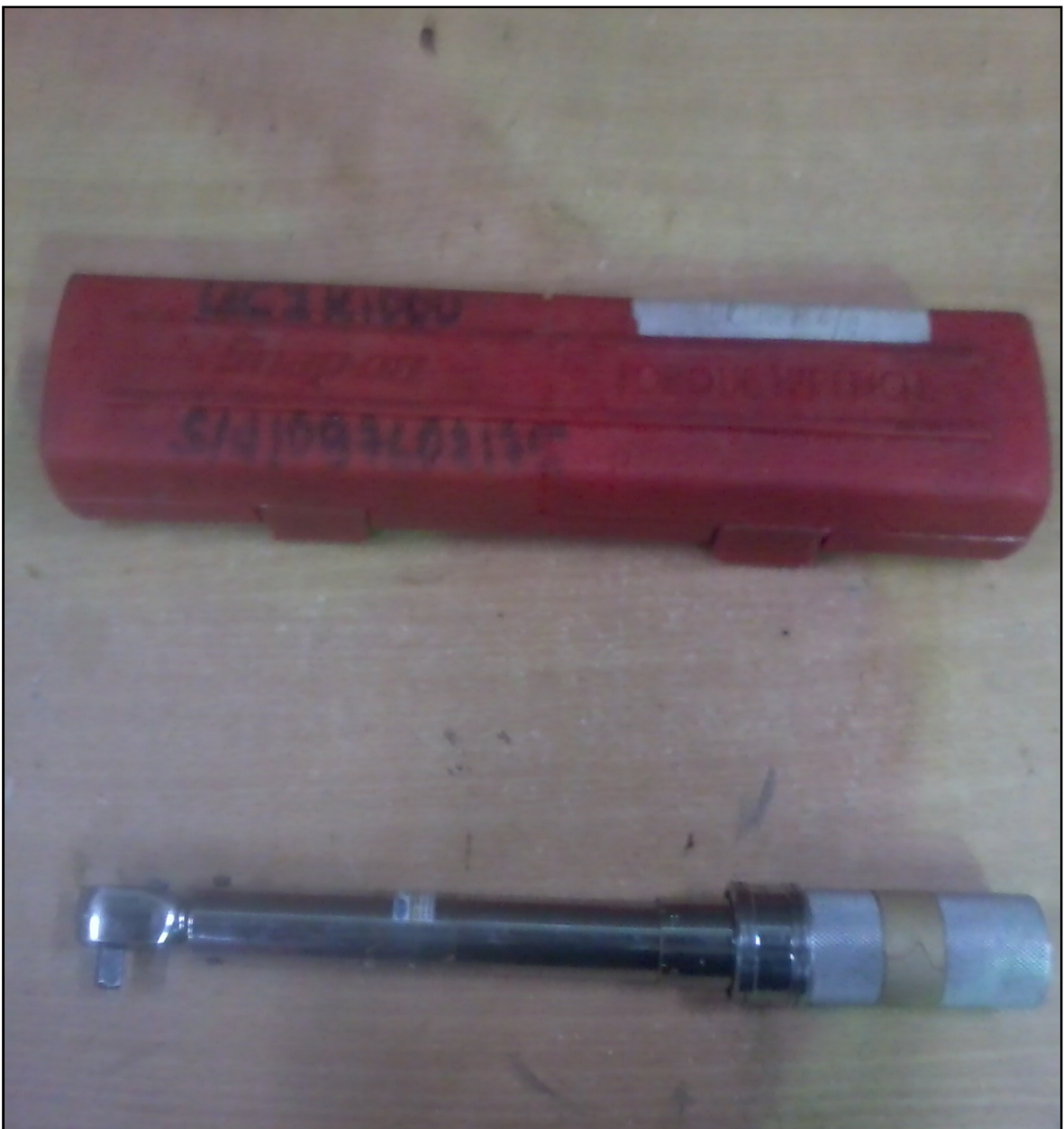
Figura 3.20: Torquímetro de 1000 libras por pulgadas
