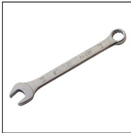
Figura 3.18: Llave de \frac{3}{4} utilizada para el ajuste del estabilizador vertical
