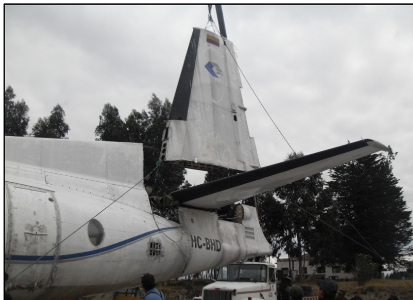
Figura 3.9: Alineación total del estabilizador vertical
