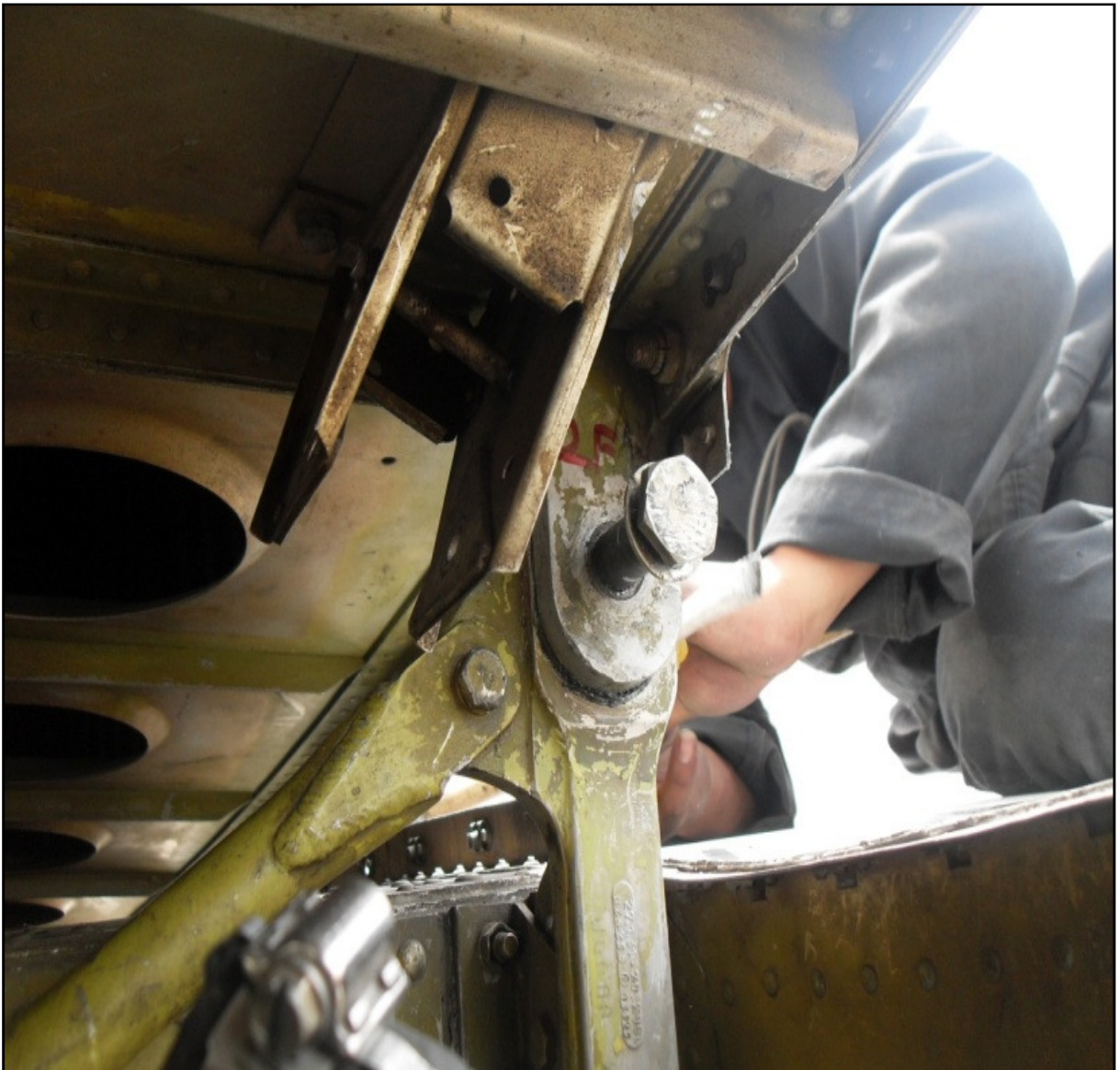
FIGURA 3.15: Colocación del perno en el fitting
