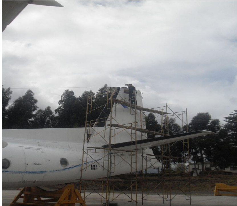
Figura 3.27: Remoción de las eslingas del Estabilizador vertical
