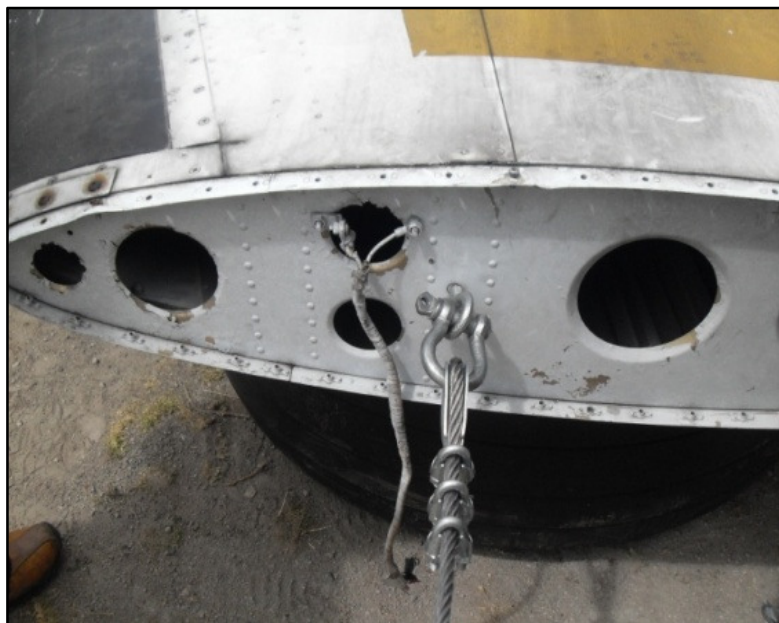
Figura 3.5: Perno de izado del estabilizador vertical
