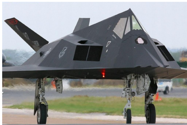
Figura 2.17: Estabilizador en V
