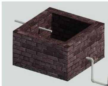
*Nota.* La ilustración muestra la configuración de la trampa de grasa con su entrada y salida de agua.
