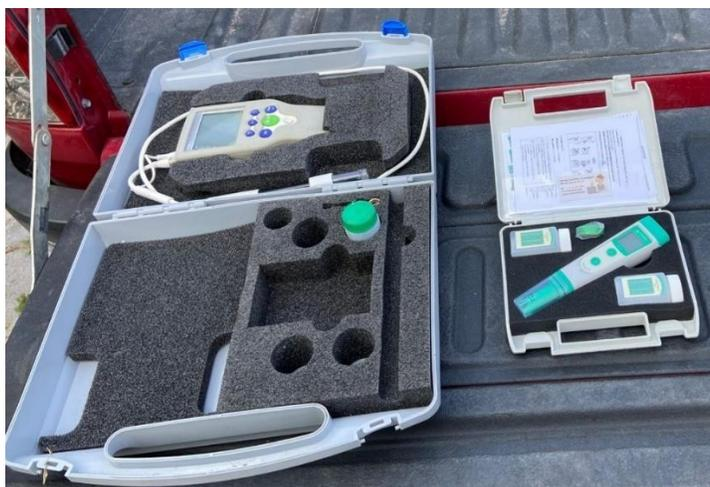
*Nota.* La imagen muestra los equipos que se utilizaron para medir los parámetros de pH, conductividad eléctrica y temperatura.
