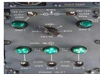
Jalando el FIRE switch del motor 1 o 3 mientras es usado el wing anti-ice cerrara automáticamente la shutt off valve
