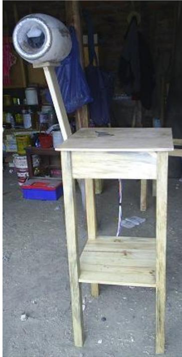
**Figura N° 3.4:** Uniones de los motores a la mesa
