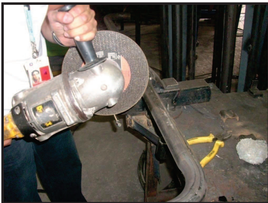
Figura 3.8 Corte de las vigas estructurales
