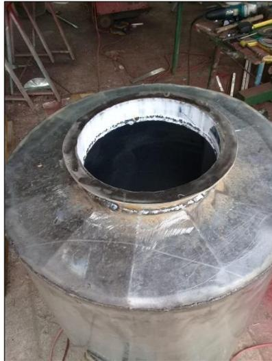
**Figura 25** Acceso para inspección y mantenimiento
