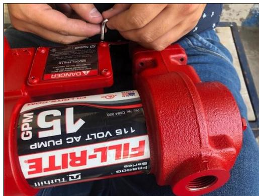
**Figura 27** Extracción de la cubierta de la caja de conexiones
