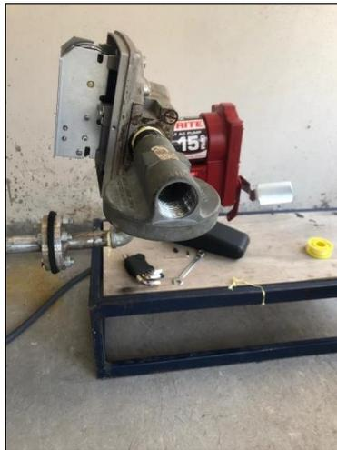
**Figura 35** Colocación del cabezal a la salida del contador
