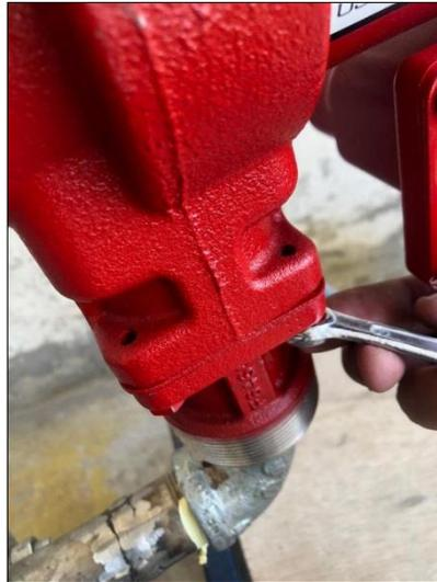
**Figura 33** Ajuste de los cuatro pernos entre la bomba y el adaptador.
