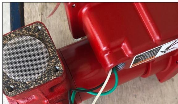
**Figura 32** Rejilla y empaquetadura del ducto de entrada del fluido a la bomba
