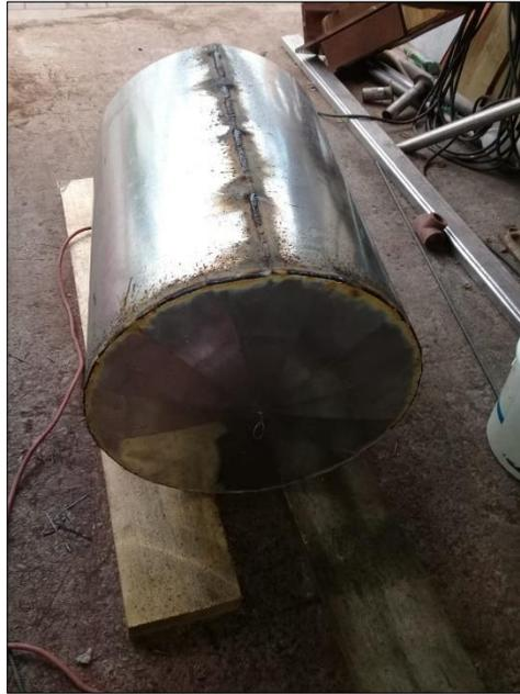
**Figura 22** Unión de los extremos de la lámina y la base.
