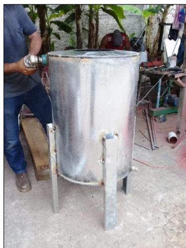
**Figura 24** Unión de la primera sección al tanque.
