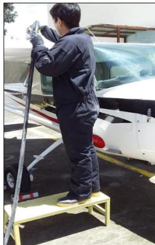
**Figura 39** Abastecimiento de combustible a la aeronave Cessna 150M
