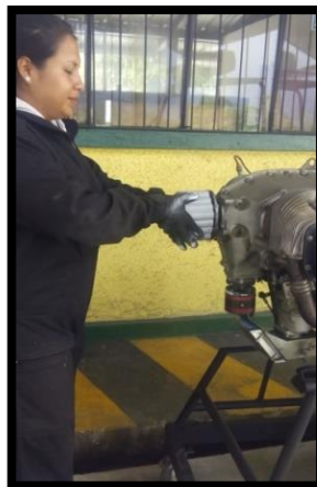
Figura 33 Instalación del espaciador
