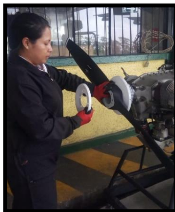
Figura 35 Instalación del mamparo delantero
