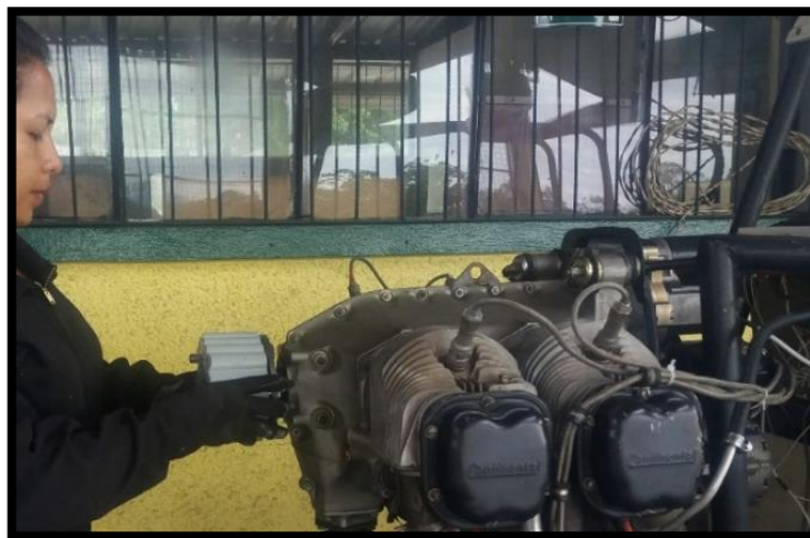
Figura 24 Remoción del espaciador
