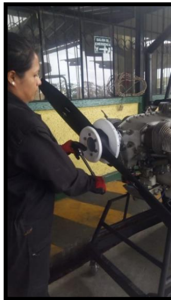
Figura 37 Ajuste de pernos con herramienta manual
