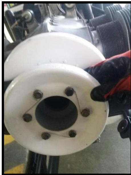
Figura 21 Alambre de freno en los pernos
