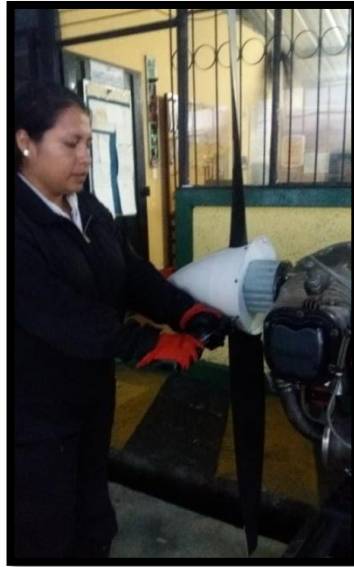
Figura 42 Ajuste de tornillos del spinner
