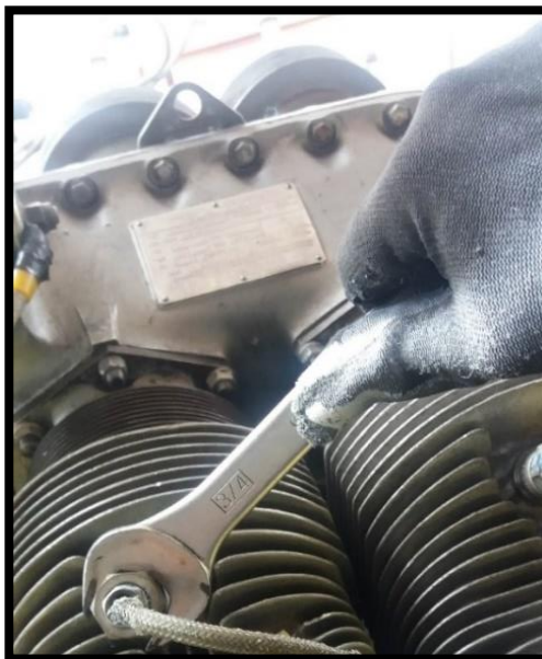
Figura 44 Ajuste de arnés de encendido
