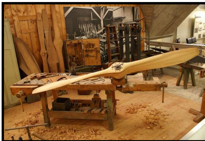
Figura 2 Hélice de madera de paso fijo Fuente: (Great bustard's flight, 2019)
