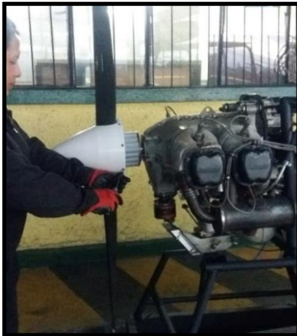
Figura 19 Remoción de pernos y spinner
