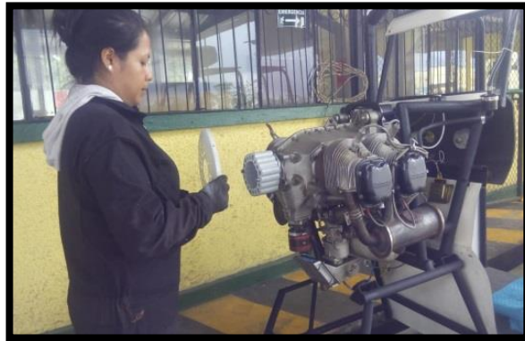
Figura 34 Colocación del mamparo posterior del spinner
