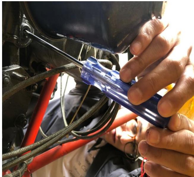
Figura 47 Regulación de presión de aceite
