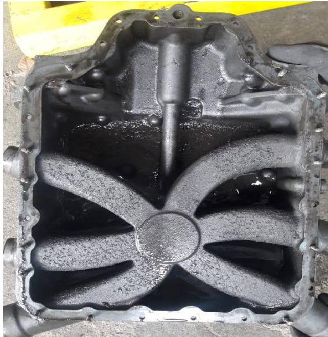
Figura 33 Restos de impurezas de aceite
