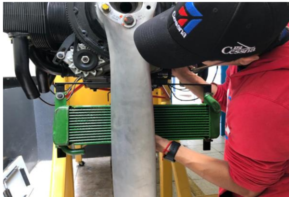
Figura 45 Instalación enfriador de aceite
