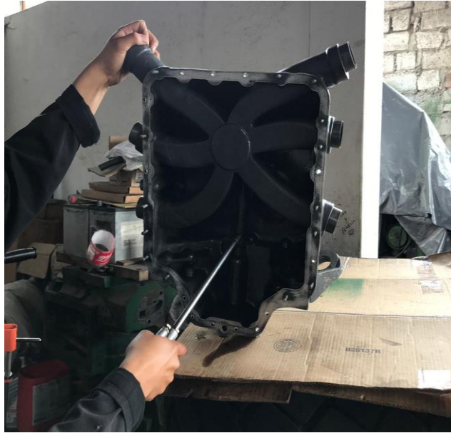
Figura 32 Inspección de condición del sumidero
