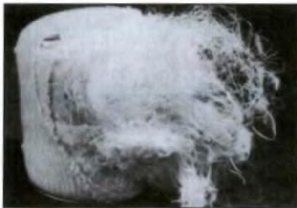
Figura 21 Un filtro de profundidad Fuente: (Sanderson, 2011)
