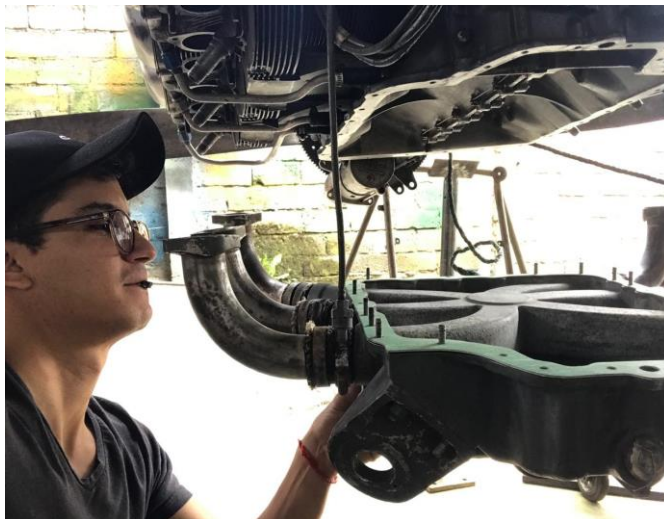
Figura 31 Desmontaje del tanque de aceite
