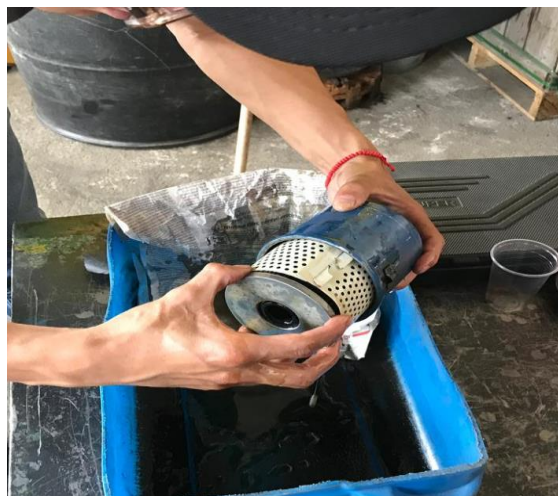
Figura 39 Reemplazo del filtro
