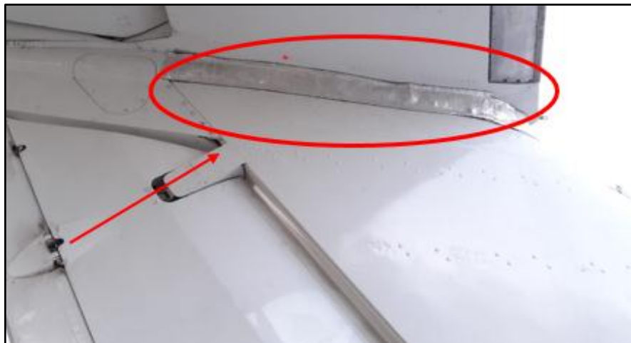
Figura 36 Adherencia con cinta de aluminio al área expuesta al medio ambiente
