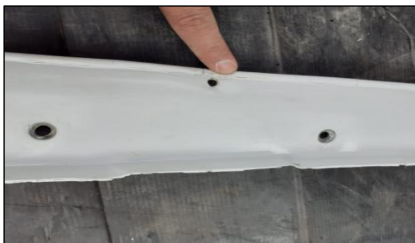
Figura 38 Identificación de discontinuidad en carenado
