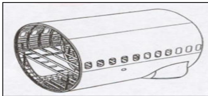
Figura 7 Estructura de tipo semimonocasco
