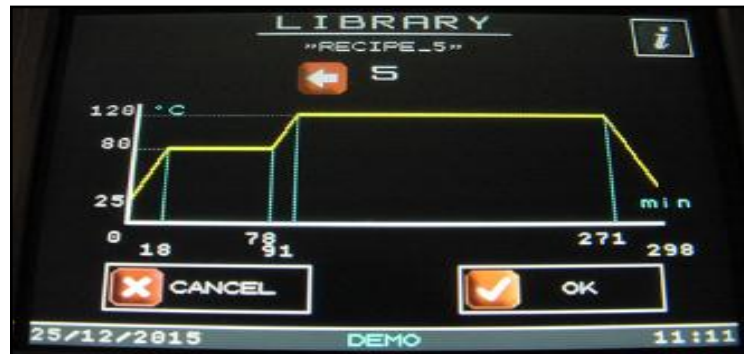
Figura 25 Diagrama tiempo vs temperatura en el proceso de curado acelerado controlado con Hot Bonder Composite
