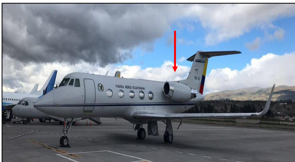
Figura 20 Posición de los Motores del G-III
