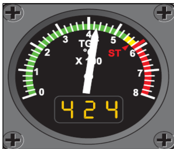
Figura 31 Indicador de temperatura del gas de la turbina (TGT)
