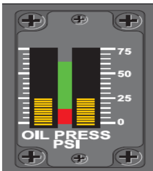
Figura 25 Indicador de presión Fuente:(FlightSafety International, 2004)
