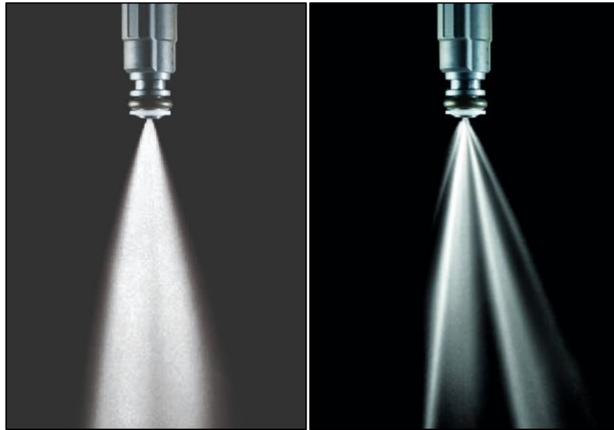
Figura 9 Pulverización del combustible en un inyector.
