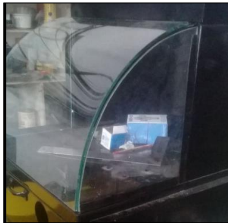
Figura 33 Vidrio de cubierta instalado.
