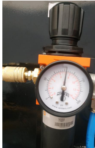
Figura 62 Filtro regulador ajustado a 100psi.
