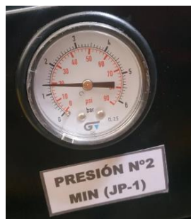
Figura 14 Manómetro de Presión N°2 Min a 20psi
