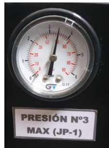
Figura 20 Manómetro de Presión N°3 Max a 50psi
