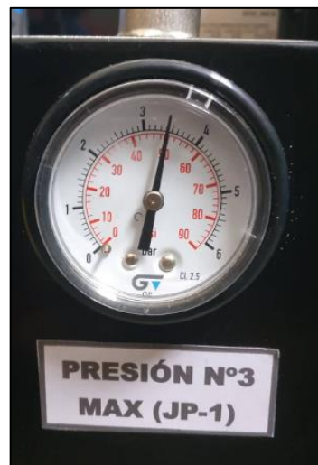
Figura 65 Manómetro presión N°3 a 50psi.
