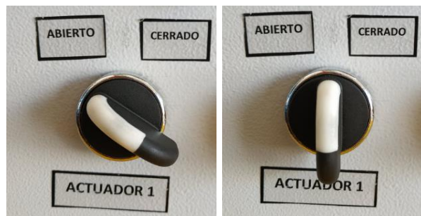
Figura 6 Accionamiento en posición ABIERTO y NEUTRO
