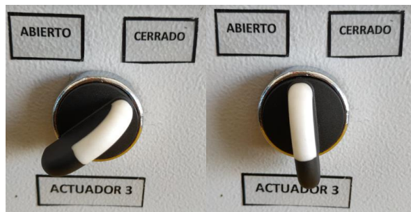
Figura 23 Accionamiento en posición CERRADO y NEUTRO
