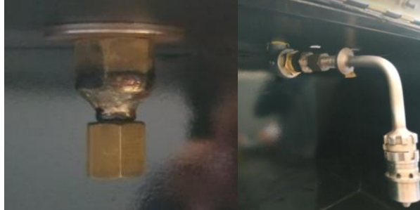
Figura 10 Acoples para los Inyectores del motor Roll Royce Viper
