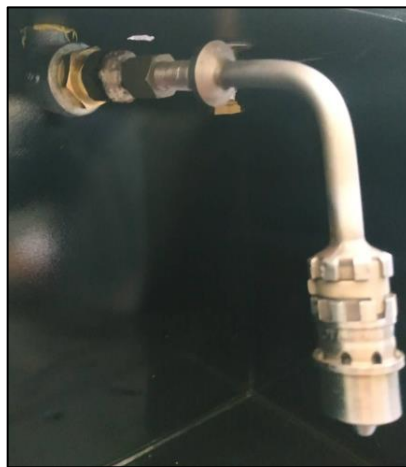
Figura 61 Inyector instalado en el acople.
