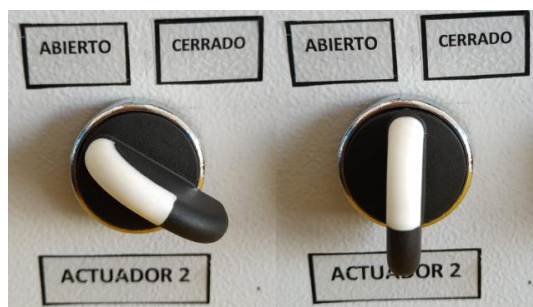
Figura 15 Accionamiento en posición ABIERTO y NEUTRO
