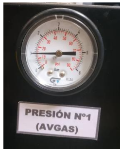
Figura 5 Manómetro de Presión N°1 a 12psi
