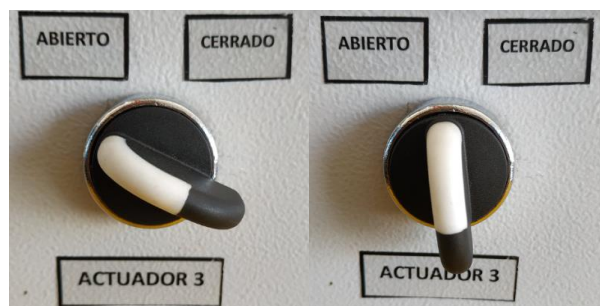
Figura 21 Accionamiento en posición ABIERTO y NEUTRO
