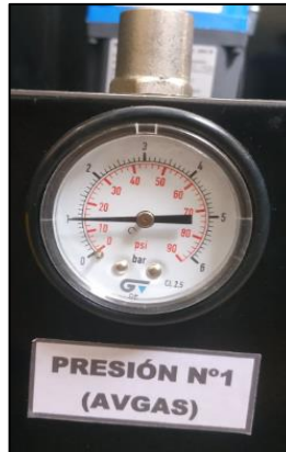
Figura 68 Manómetro presión N°1 a 12psi.
