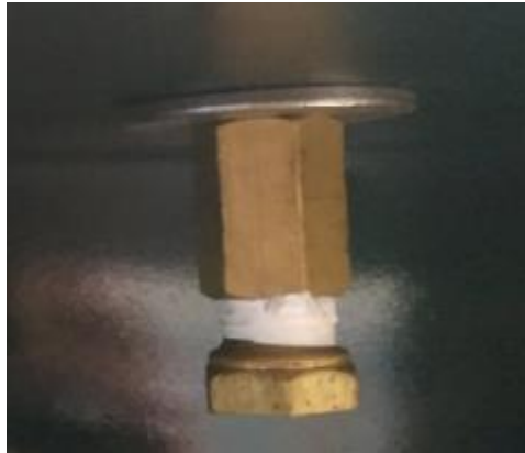
Figura 53 Instalación de los acoples del inyector.
