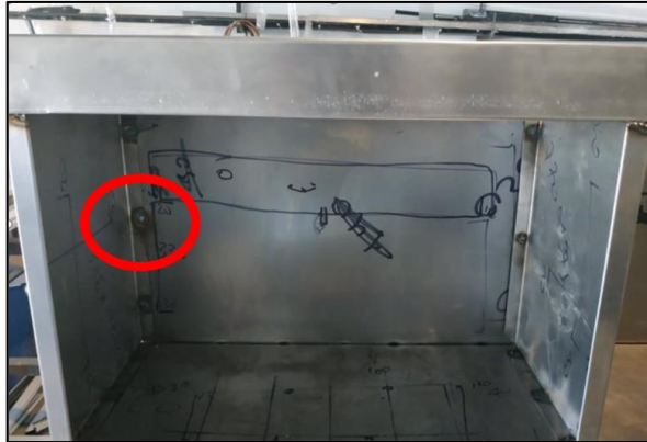
Figura 30 Puntos de suelda pulidos.
