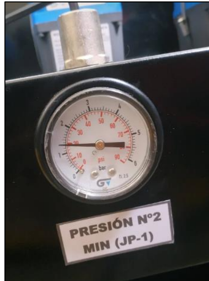
Figura 63 Manómetro presión N°2 a 20psi.
