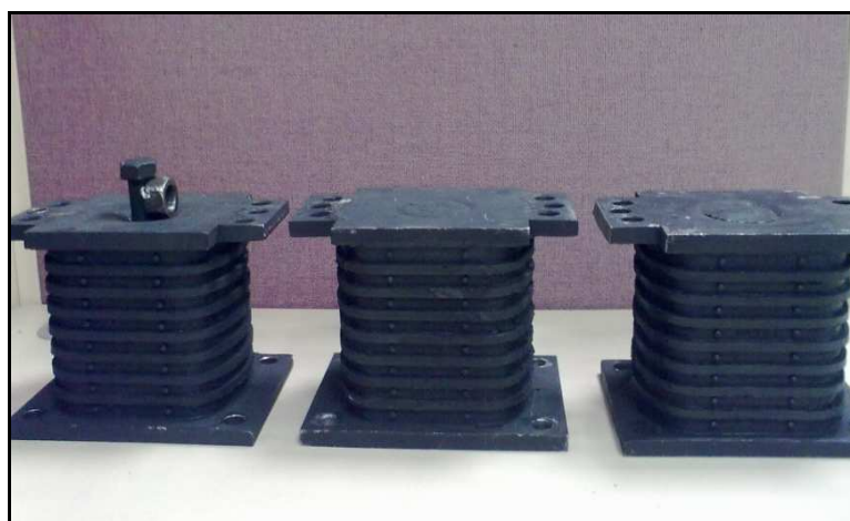
Figura 3 Aisladores de base ensayados en la ESPE.
