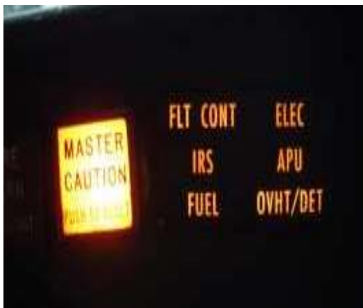
Figura 2.3 Indicación del FWS del Boeing 737-800.
