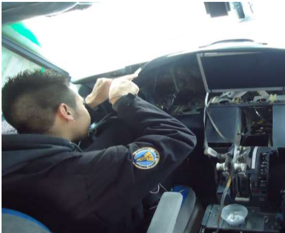
Figura 3.9 Instalación del arnés eléctrico.
