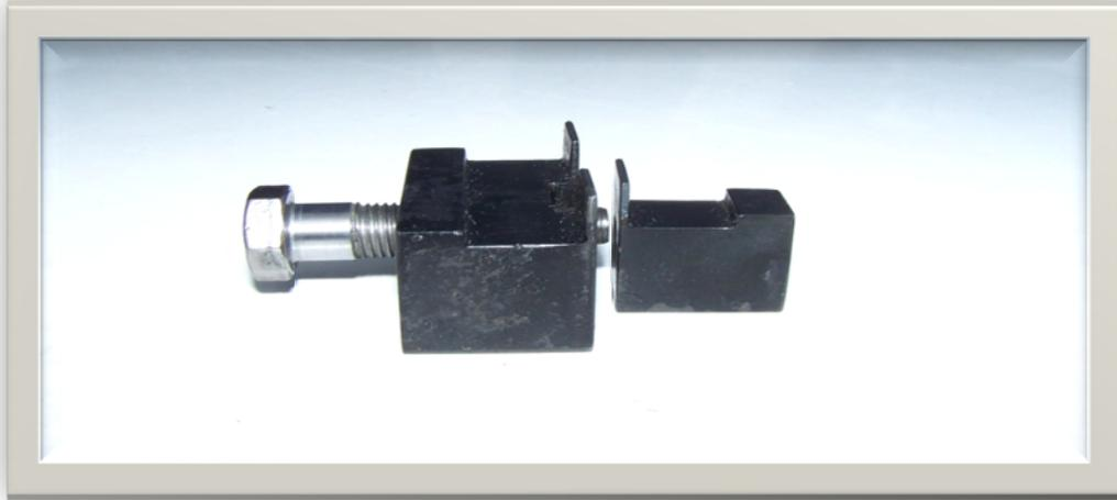
Foto N° 5.herramienta para la instalación y remoción del trunnion del cuerno de cambio de paso
