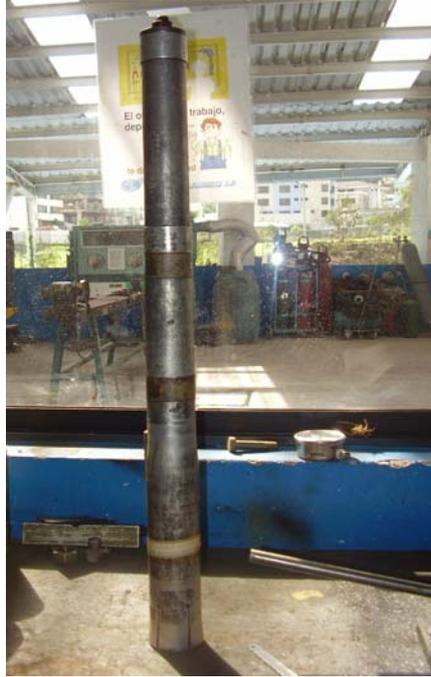
Herramienta para la extracción del excluder del rotor principal.
