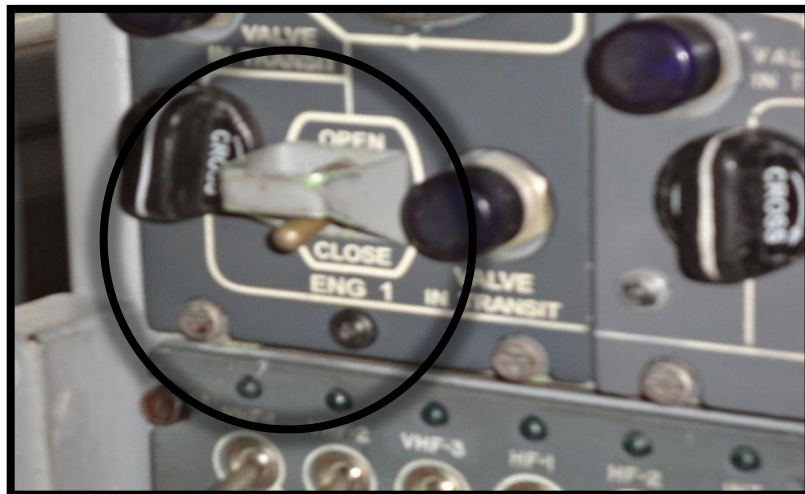
Figura 3.2: Switch de la válvula shutoff Elaborado por: Jonathan Zurita
