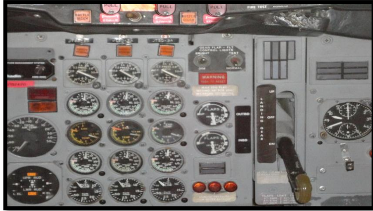
Figura 2.47: Sistema de Indicadores del motor Fuente: Manual de mantenimiento parte 76-11-00, pág.3
