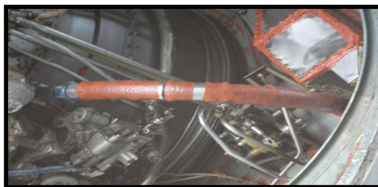
Figura 3.14: Manguera de suministro de combustible Elaborado por: Jonathan Zurita
