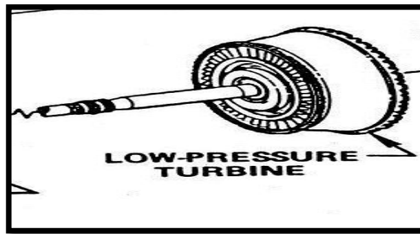
Figura 9: Turbina de baja (low pressure turbine) Fuente: Magnético FEDEX del avión Boeing 727, diapositiva 50 Realizado por: Jonathan Zurita
