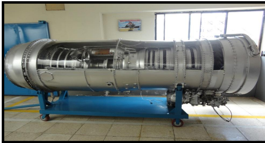
Figura 3.29: Motor seccionado Elaborado por: Jonathan Zurita
