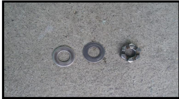
Figura 3.25: Remoción de la tuerca y de las arandelas de los montantes Elaborado por: Jonathan Zurita
