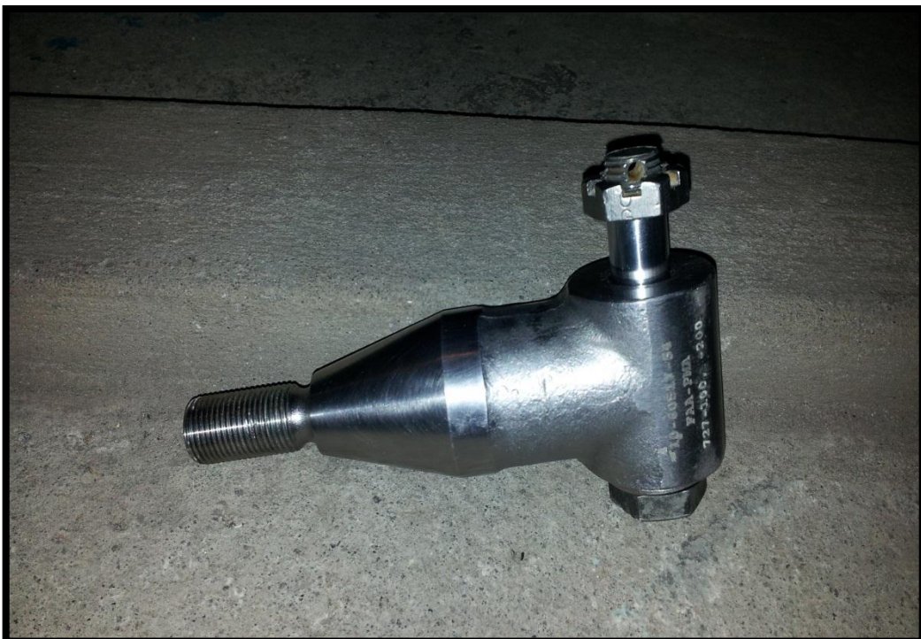
Imagen E2: Desmontaje de los cone bolt
