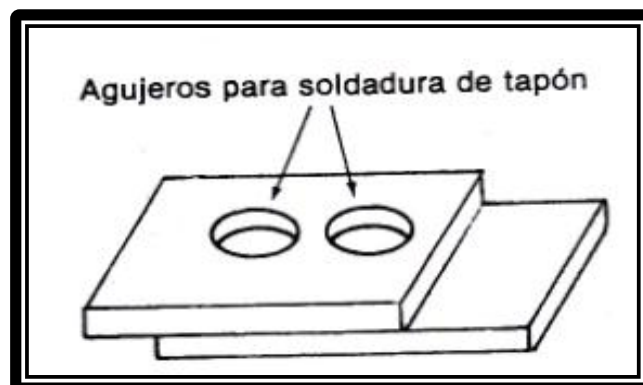
Figura 2.6 Soldadura de tapón y Agujero alargado
