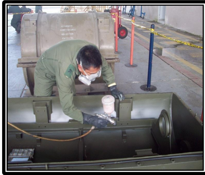
Figura 3.8 Aplicación de Pintura
