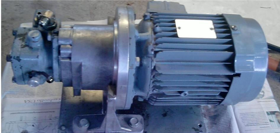
Figura 2.8 bomba hidráulica y motor
