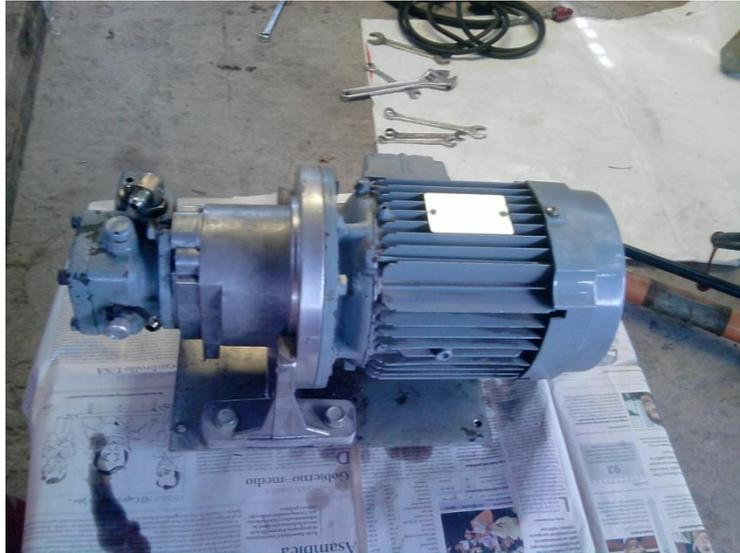
**Figura 3.13 Unión de la bomba y el motor.**
