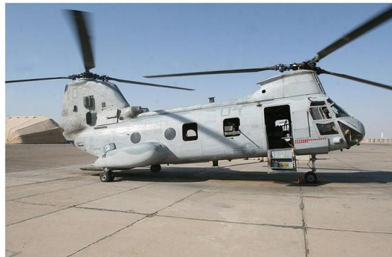
Figura 3.3 Rotores contra rotatorios
