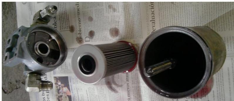
**Figura 3.8 Filtro hidráulico**
