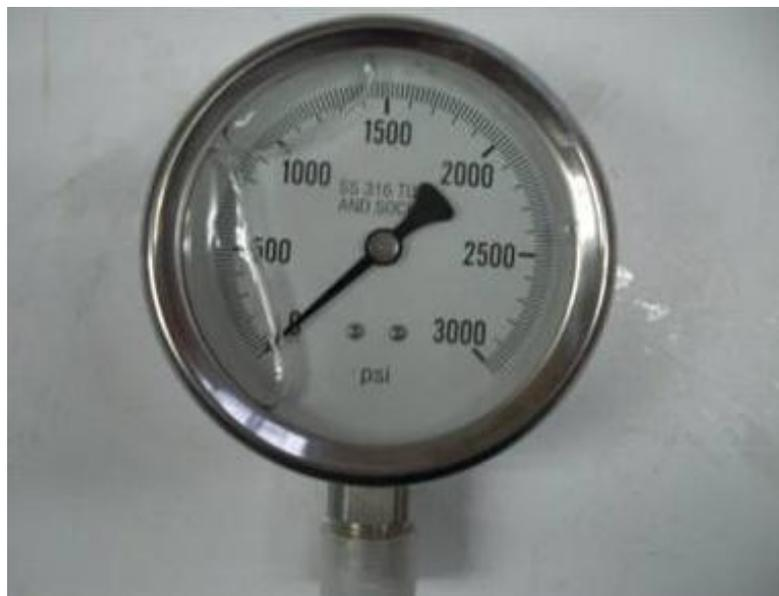
**Figura 3.16 manómetro de presión de 0 a 3000 PSI**
